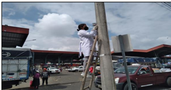
Figura 4-3: Colocación de muestreados pasivo para \text{SO}_2 y \text{NO}_2 Realizado por: Manotoa, Cynthia, 2022.
