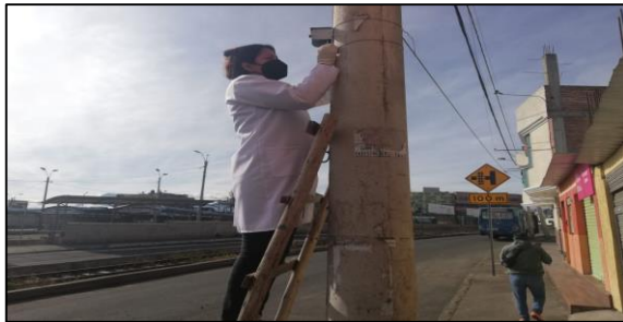
Figura 3-3: Colocación de muestreados pasivo para \text{SO}_2 y \text{NO}_2 Realizado por: Manotoa, Cynthia, 2022.
