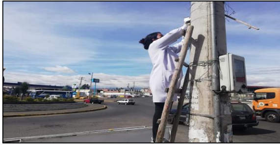
Figura 2-3: Colocación de muestreados pasivo para \text{SO}_2 y \text{NO}_2 Realizado por: Manotoa, Cynthia, 2022.
