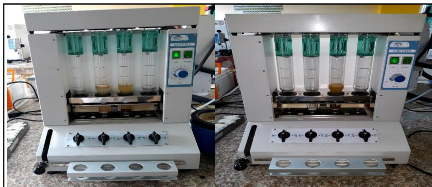
Figura 2-2: Equipo Dosi-Fiber para la determinación de lignina y celulosa
