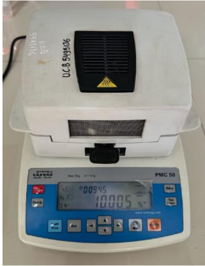
Ilustración 4: Determinación de humedad
