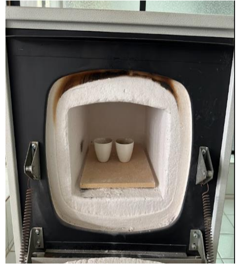
Ilustración 5: Determinación de cenizas totales
