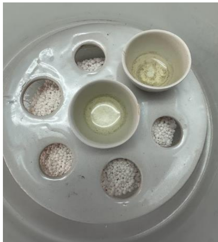
Ilustración 6: Determinación de cenizas en agua y HCl
