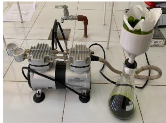
Ilustración 10: Filtración de extracto etanólico y acuoso
