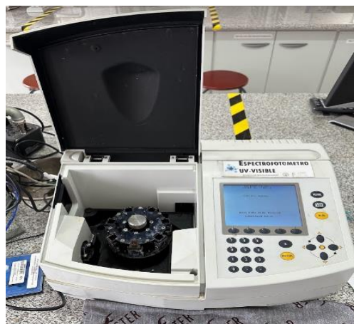
Ilustración 20: Lectura de las absorbancias en el espectrofotómetro
