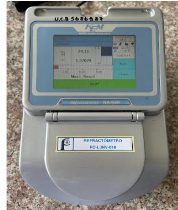
Ilustración 14: Determinación de índice de refracción
