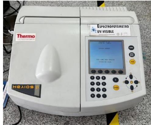
Ilustración 25: Lectura de las absorbancias en el espectrofotómetro
