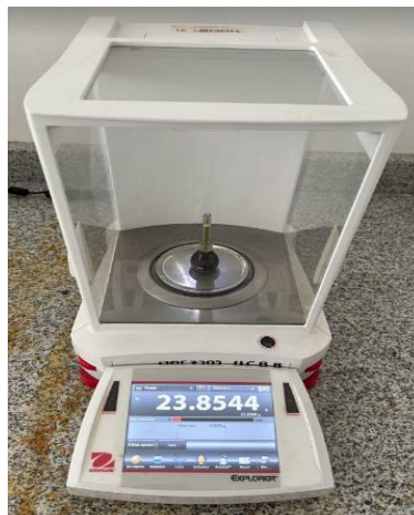
Ilustración 15: Determinación de densidad relativa
