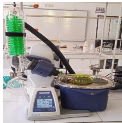
Concentración del extracto en el rotapavor
