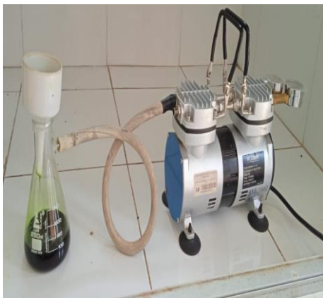
Filtración del extracto al vacío
