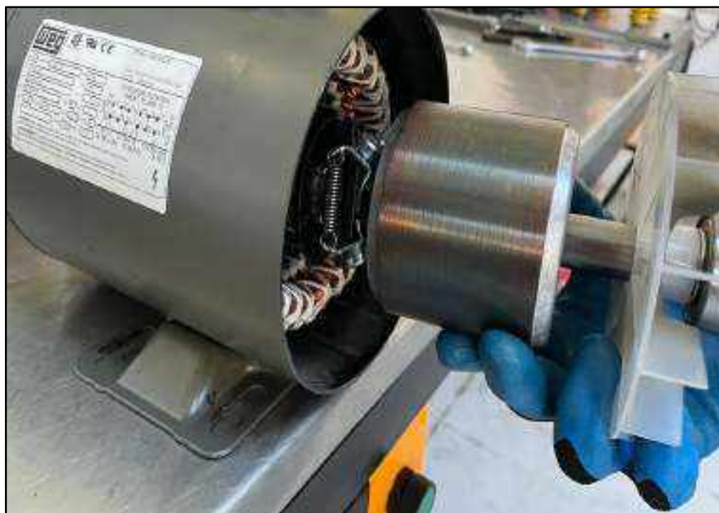
Ilustración 12-4: Montaje de rotor en la carcasa del motor
