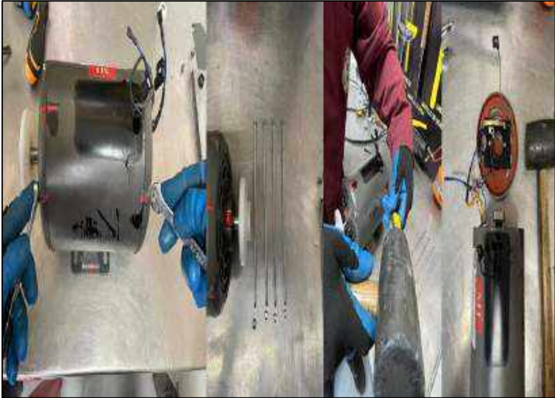
Ilustración 10-4: Forma de extracción de tornillos extralargos y tapa posterior del motor
