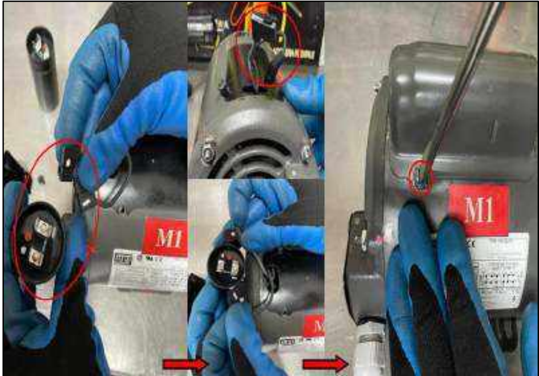
Ilustración 14-4: Montaje de condensador
