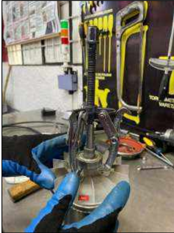
Ilustración 13-4: Extracción de rodamiento 6203Z del eje
