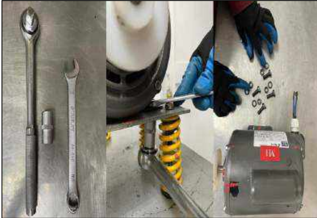
Ilustración 7-4: Desmontaje de la placa superior
