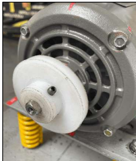
Ilustración 3-31: Polea de nylon asegurado con el prisionero
