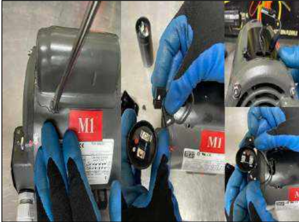
Ilustración 8-4: Desmontaje del condensador
