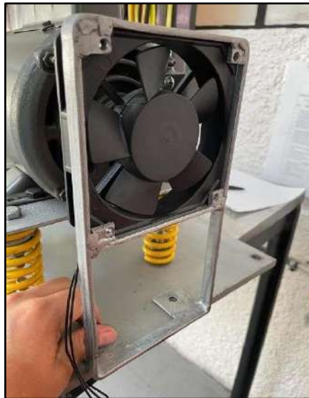
Ilustración 3-18: Resultado de la base del ventilador
