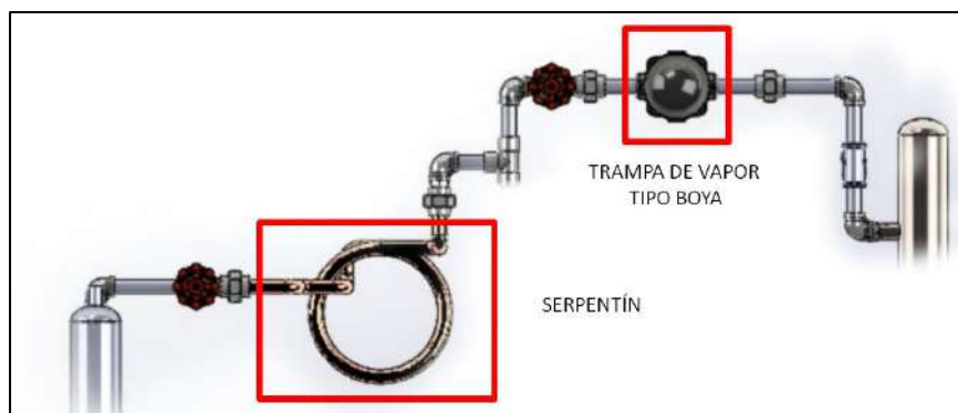
Ilustración 4-6: Diseño del tramo 1 del banco de pruebas
