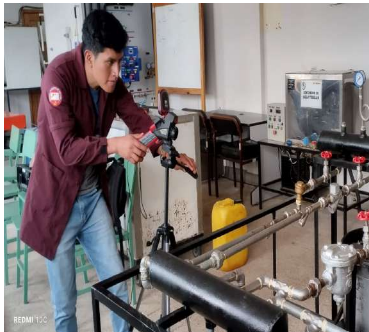
Ilustración 4-29: Pruebas de termográfica en el tramo 4
