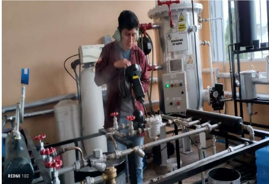
Ilustración 4-18: Pruebas de ultrasonido en el tramo 2
