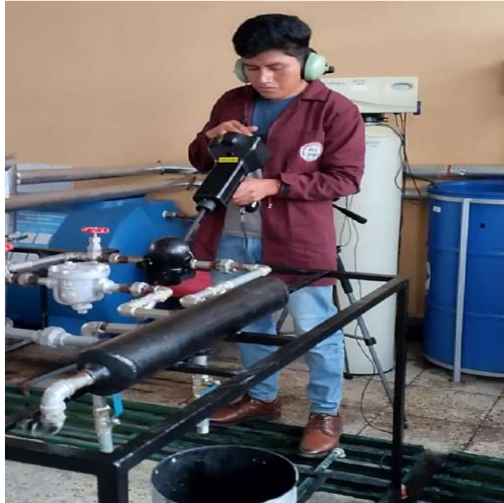
Ilustración 4-12: Pruebas de ultrasonido en el tramo 1
