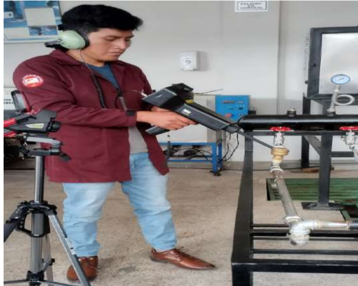
Ilustración 4-30: Pruebas de ultrasonido en el tramo 4
