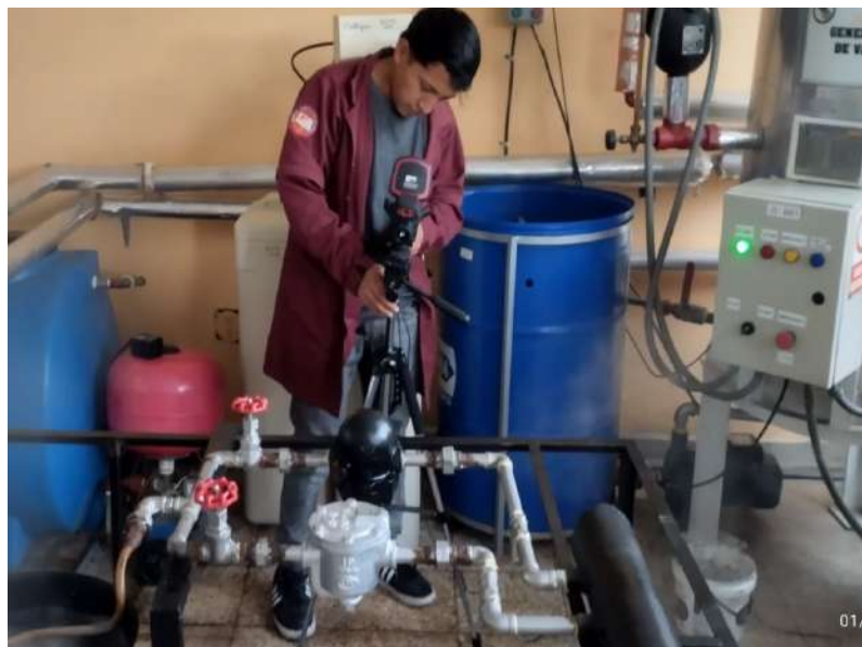
Ilustración 4-11: Pruebas de termográfica en el tramo 1
