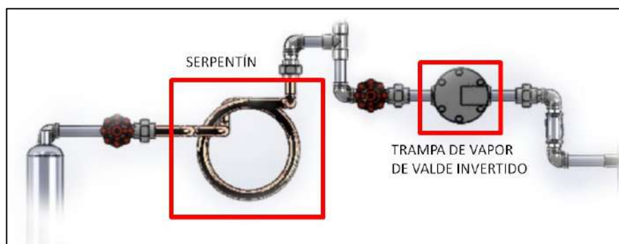
Ilustración 4-13: Diseño del tramo 2 del banco de pruebas
