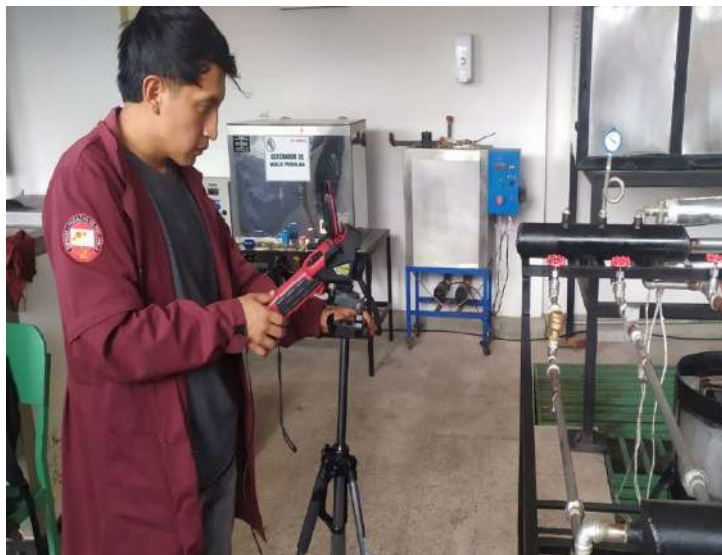
Ilustración 4-23: Pruebas de termográfica en el tramo 3
