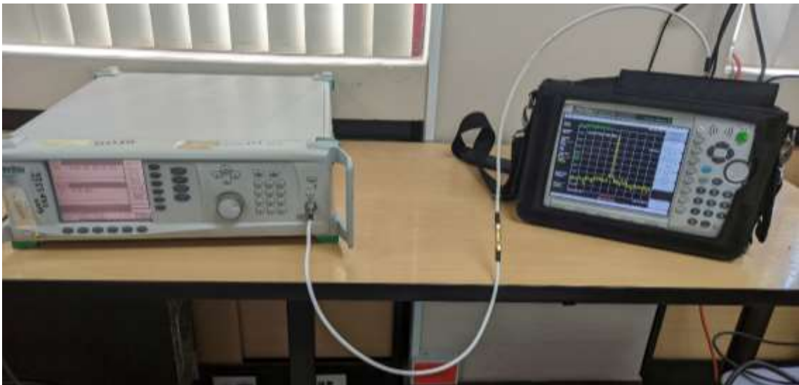
Ilustración 3-7: Pruebas de recepción sin los amplificadores
