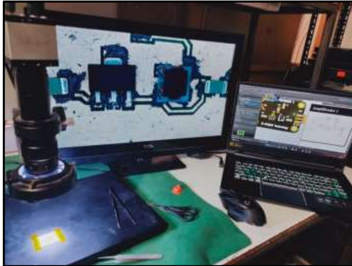
Ilustración 3-5: Colocación de los componentes en cada placa
