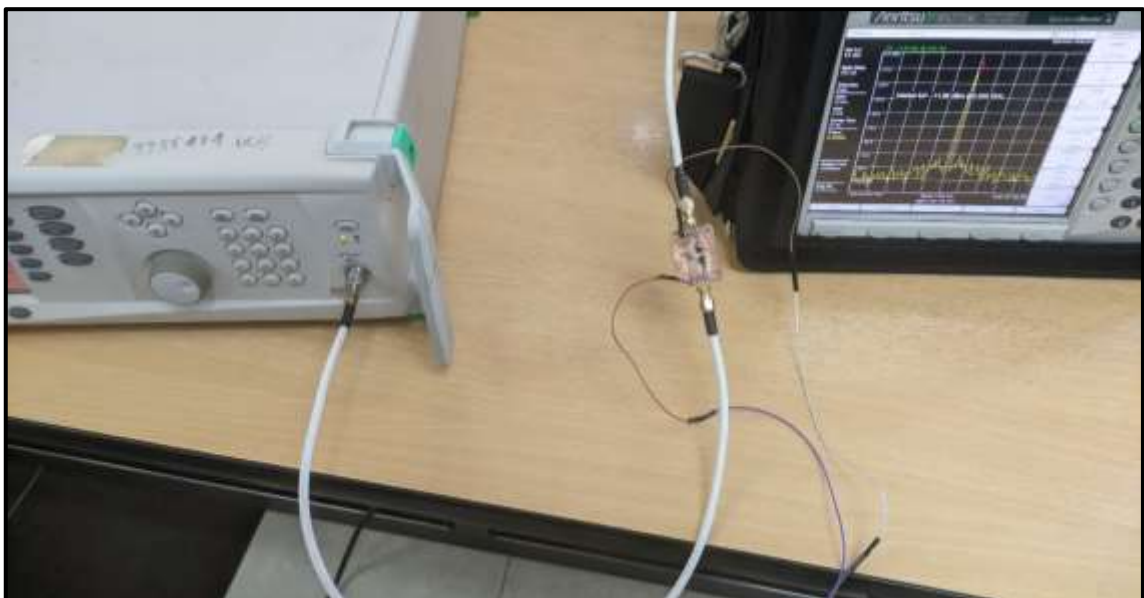
Ilustración 3-9: Conexión y toma de medidas del amplificador PHA-1H+
