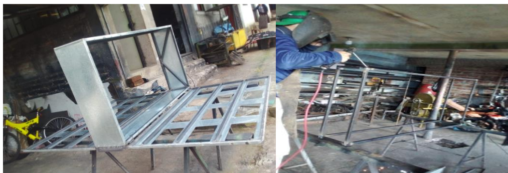
Ilustración 3-3: Diseño de la estructura metálica
