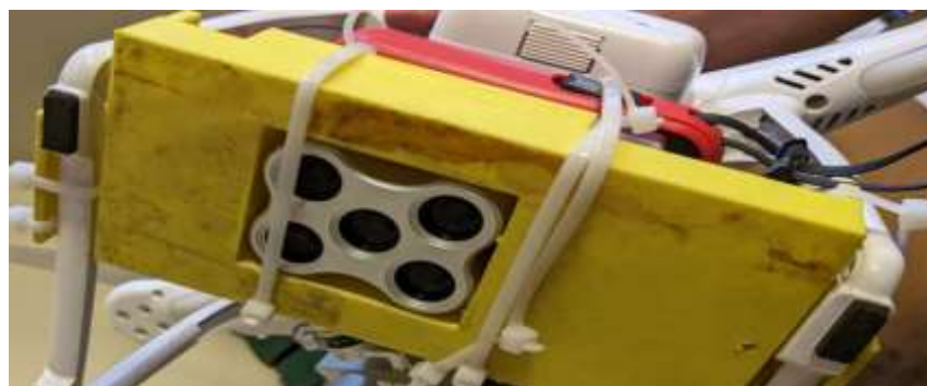
Ilustración 3-3 Montaje del acople a la cámara
