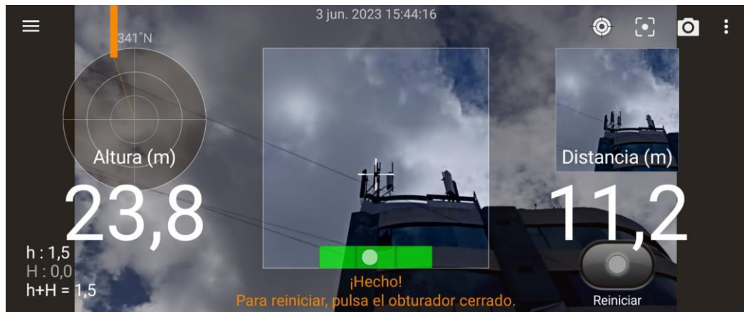
Ilustración 3-34: Medición de altura de Rb9 con Smart Measure
