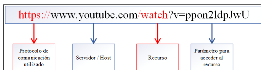
Ilustración 8-3: Parte de un Identificador de recurso uniforme (URI)
