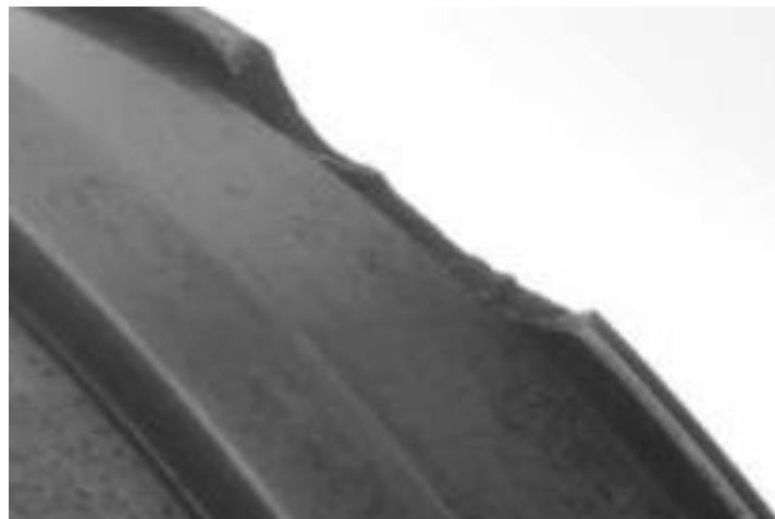
Ilustración 2-5: Borde de rodamiento fracturado.
