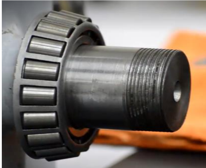
Ilustración 4-5. Montaje del primer rodamiento
