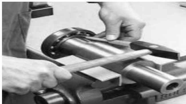
Ilustración 2-18: Desmontaje mediante punzón y martillo.
