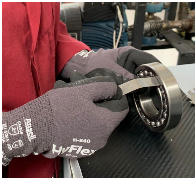
Ilustración 3-13: Medición del juego radial inicial
