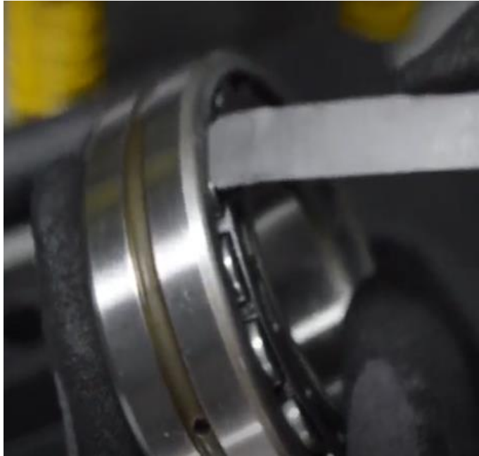
Ilustración 5-5: Juego radial interno medido
