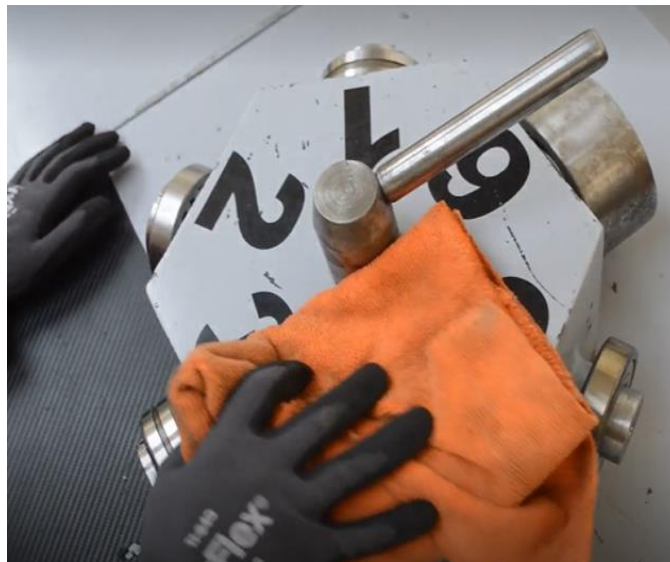
Ilustración 3-5. Inspección visual del módulo
