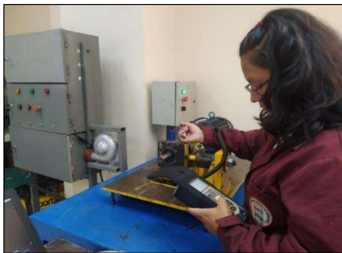
Ilustración 3- 9: Pruebas estado inicial (vibración).
