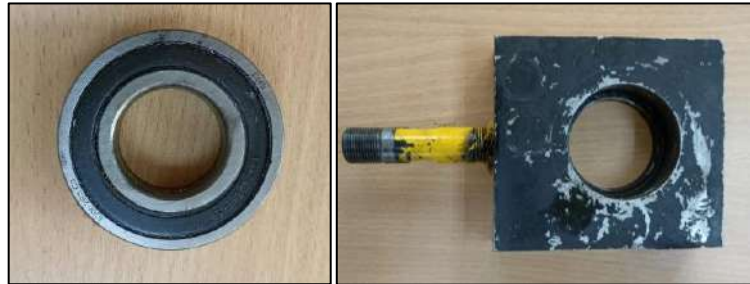
Ilustración 3- 28: Estado inicial del rodamiento y caja de rodamiento
