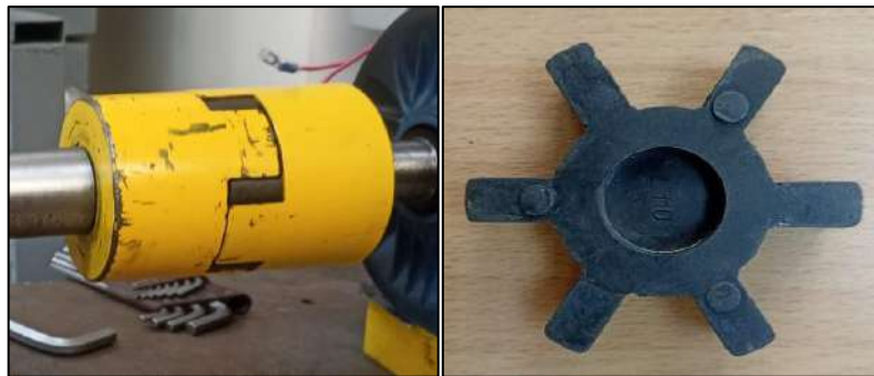
Ilustración 3- 26: Estado inicial del acople
