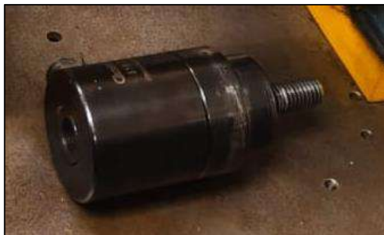
Ilustración 3- 29: Estado inicial de la bomba hidráulica.
