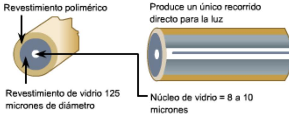
Ilustración 6-1: Arquitectura Fibra Monomodo
