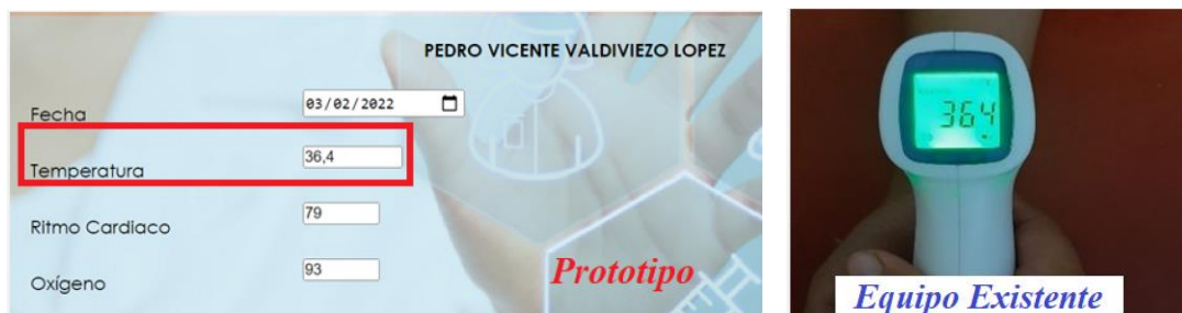
Figura 6-4: Adquisición de valores de temperatura del prototipo vs termómetro digital
