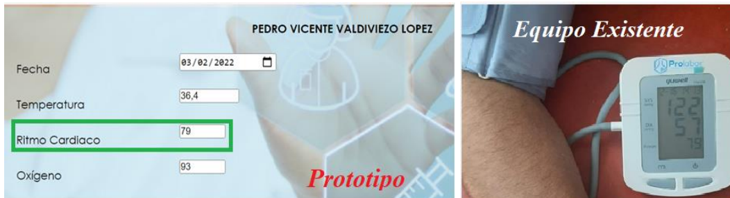
Figura 7-4: Toma de valores de ritmo cardíaco del prototipo vs medidor de presión
