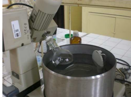
FOTOGRAFIA Nº 4. OBTENCIÓN DEL EXTRACTO ALCOHÓLICO DE LAS HOJAS DE CHOCHO 1. MACERACIÓN DEL EXTRACTO ALCOHOLICO EN EL ULTRASONIDO 2.CONCENTRACIÓN DEL EXTRACTO ALCOHÓLICO EN EL ROTAVAPOR.
