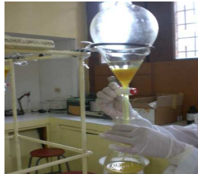
FOTOGRAFIA Nº 5. OBTENCIÓN DEL EXTRACTO ETÉREO DE LOS ALCALOIDES TOTALES DEL GRANO 1. COCCION DEL GRANO DE CHOCHO 2. EXTRACCÓN DE LOS ALCALOIDES TOTALES DEL AGUA DE COCCION CON ÉTER.
