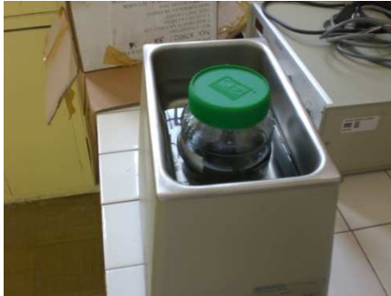
FOTOGRAFIA Nº 4. OBTENCIÓN DEL EXTRACTO ALCOHÓLICO DE LAS HOJAS DE CHOCHO 1. MACERACIÓN DEL EXTRACTO ALCOHOLICO EN EL ULTRASONIDO 2.CONCENTRACIÓN DEL EXTRACTO ALCOHÓLICO EN EL ROTAVAPOR.
