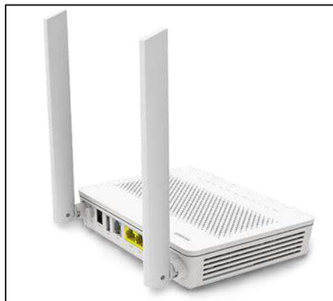
**Figura 43-2:** Terminal de Red Óptico
