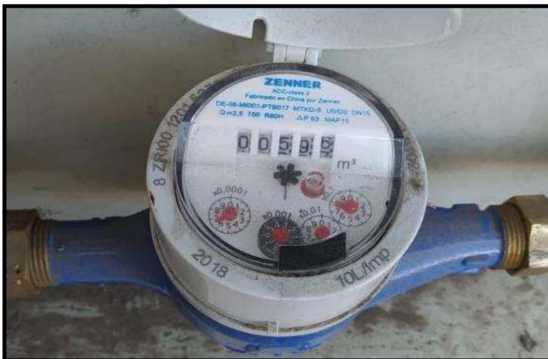
**Figura 1-2:** Medidor de agua Zenner MTKD-S modelo DE-08-MI001-PTB017.
