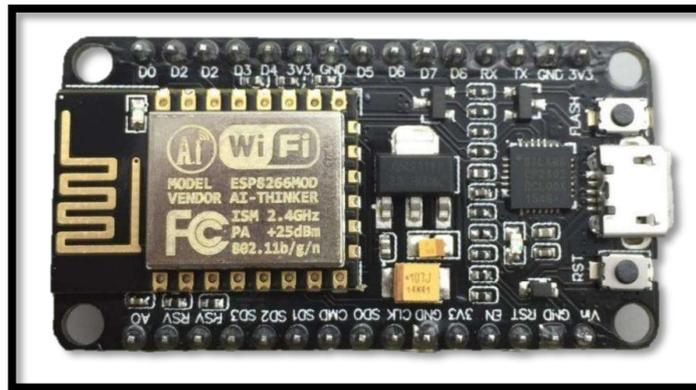
**Figura 3-3:** Tarjeta de desarrollo NodeMCU ESP8266.
