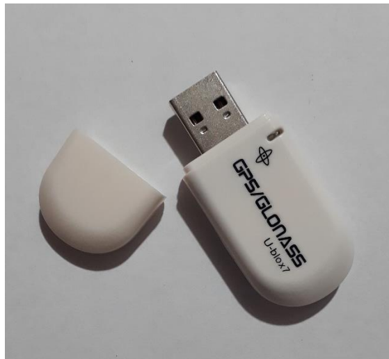
Figura 14-2: Módulo GPS U-blox 7
