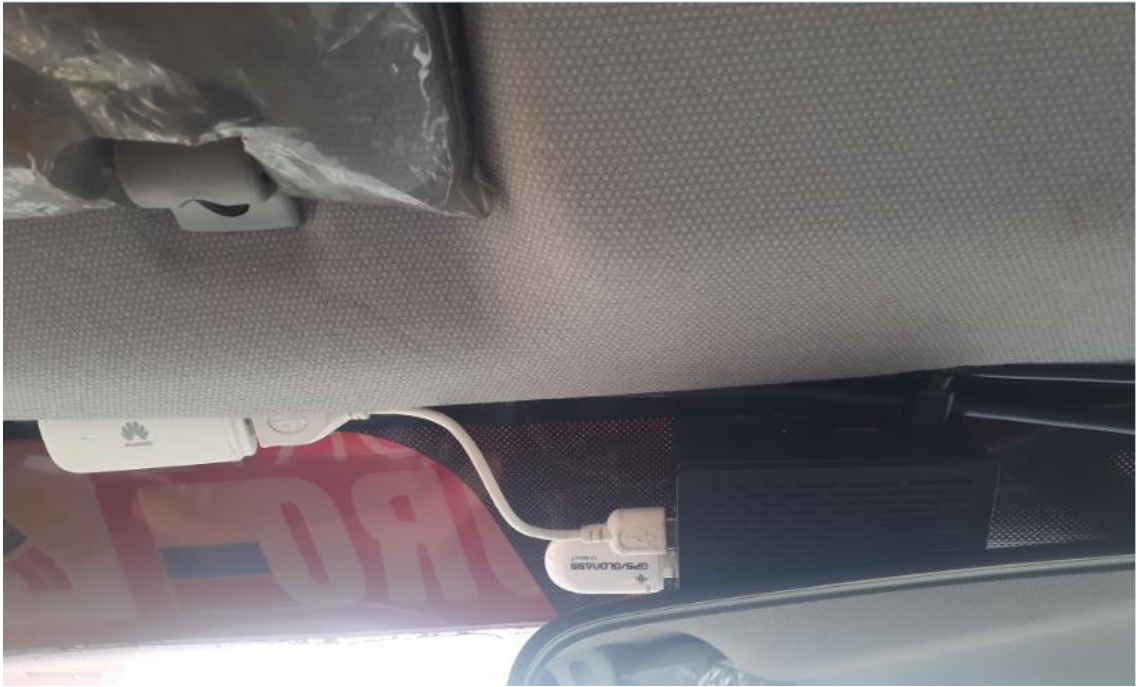
Figura 30-2: Vista frontal del dispositivo de localización en el Taxi
