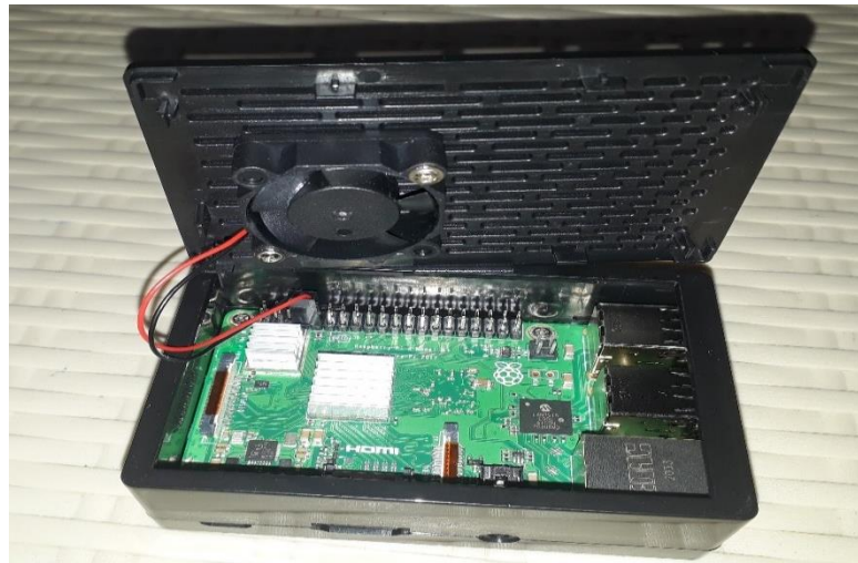
Figura 26-2: Instalación de la tarjeta en la carcasa
