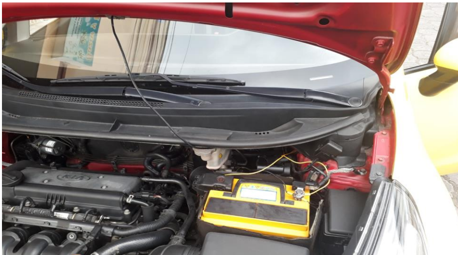
Figura 29-2: Alimentación de la batería hacia el regulador, (Cables amarillos)
