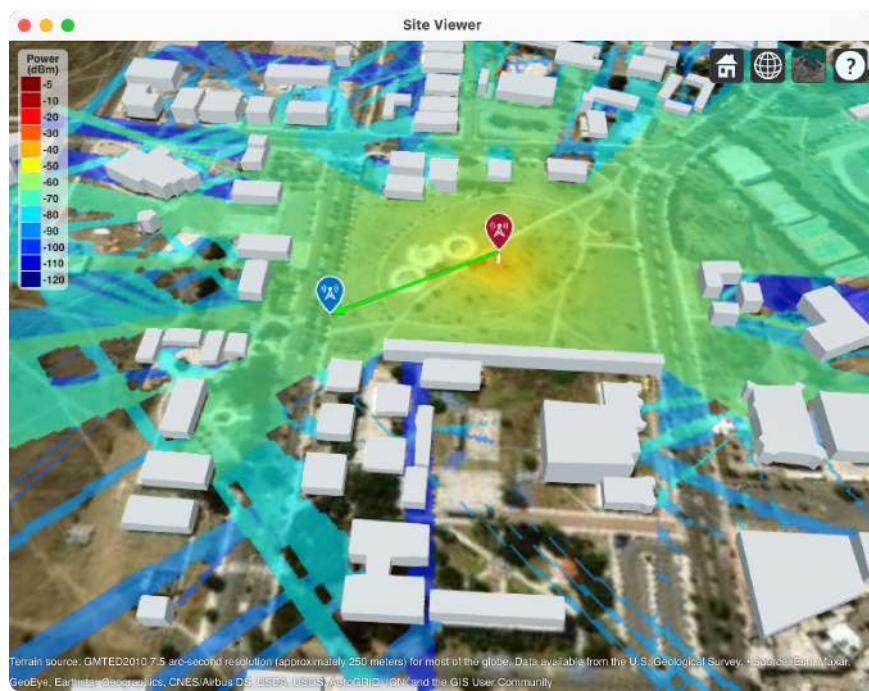
Figura 36-2: Cobertura mediante Ray Tracing en la ESPOCH. Realizado por: Bryan Sanipatin, 2021.
