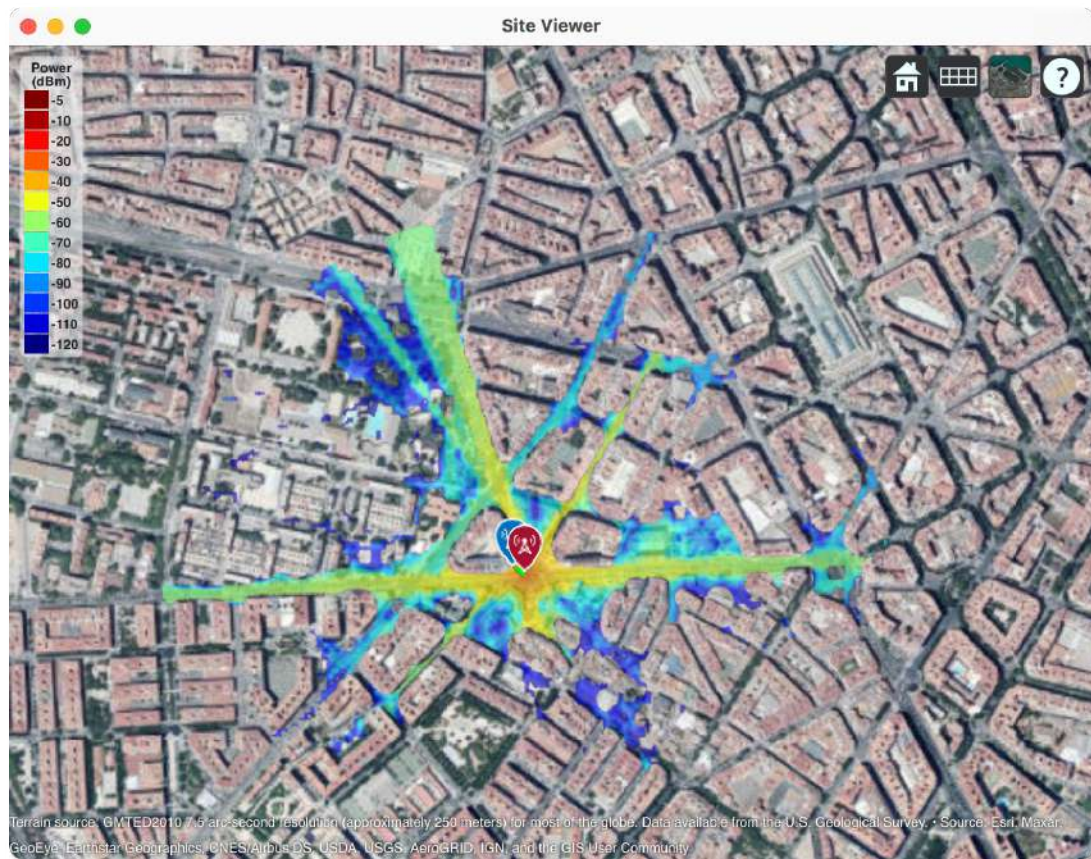
Figura 28-3: Mapa de cobertura con Ray-Tracing en Simulador Propuesto Realizado por: Bryan Sanipatin, 2021.
