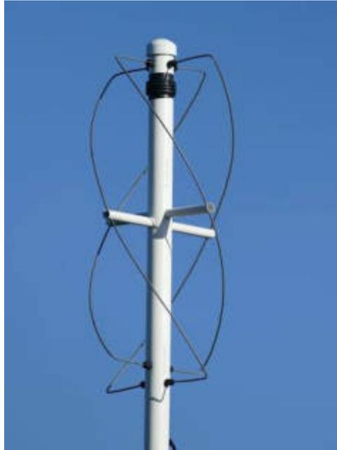
**Figura 7-1:** Antena cuadrifilar helicoidal
