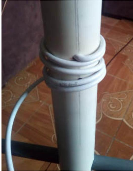
**Figura 40-2:** Proceso de enrollado del cable coaxial (Antena 2).
