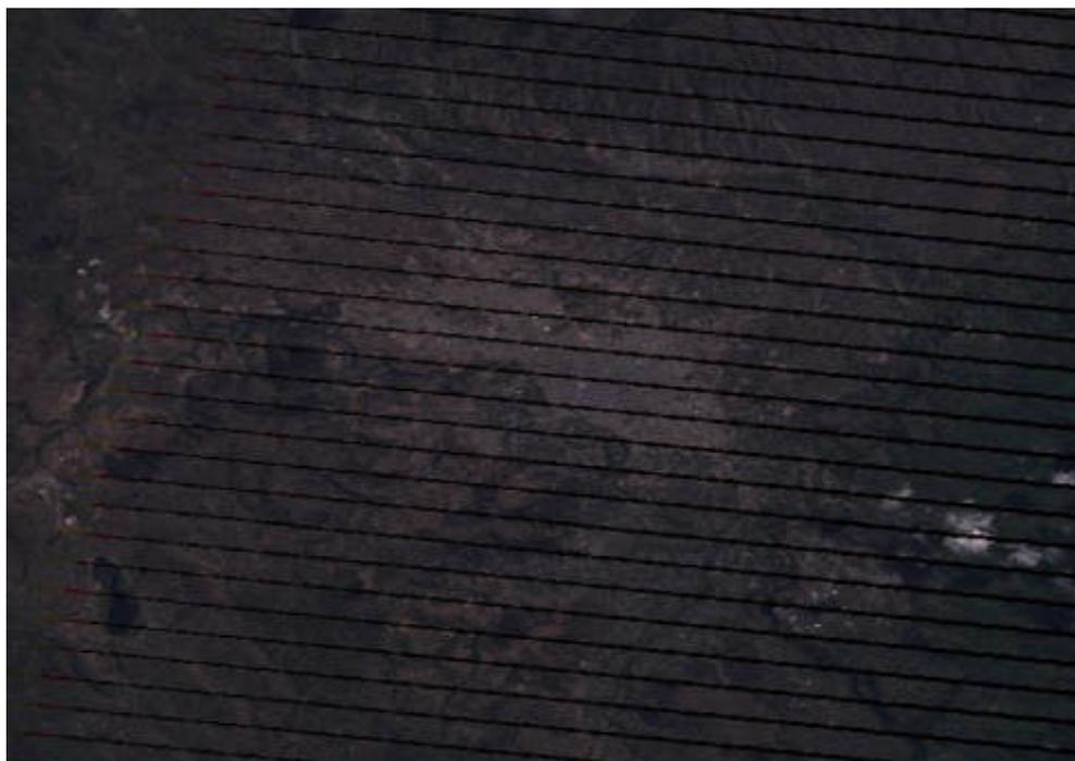
**Figura 54-3:** Imagen satelital Landsat 7 con errores radiométricos.
