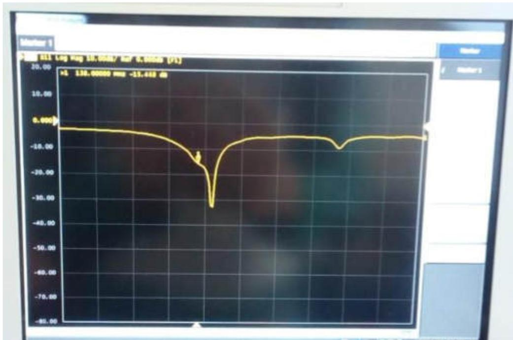
**Figura 8-3:** Resultado del VNA con la modificación final, (Antena 2).
