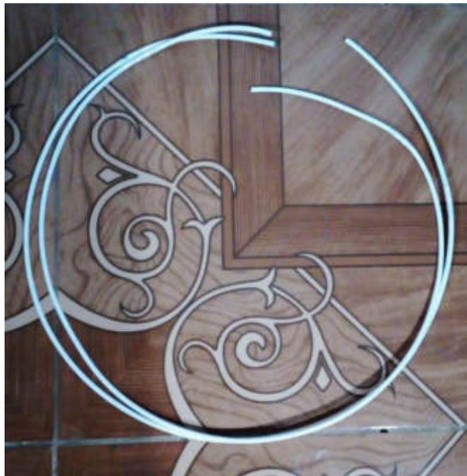
**Figura 32-2:**Espira larga, tramos A y B, cable RG-58 (Antena 1).
