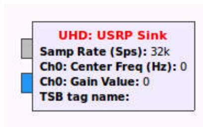
**Figura 46-2:** Bloque UHD: USRP Sink de GNU Radio.
