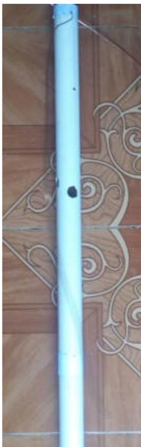
**Figura 37-2:** Mástil de la Antena Cuadrifilar Helicoidal, con inductor coaxial (Antena 2).
