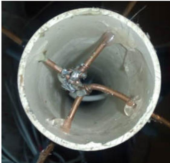
**Figura 39-2:** Conexión de las espiras en la antena (Antena 2).
