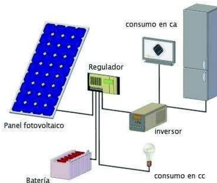
Figura 9-1: Componentes de un sistema fotovoltaico aislado de la red.
