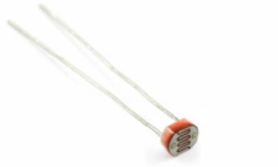
Figura 9-2: Sensor de luz LDR mini
