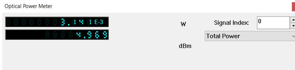
**Figura 6-3.** Potencia de salida de la OLT
