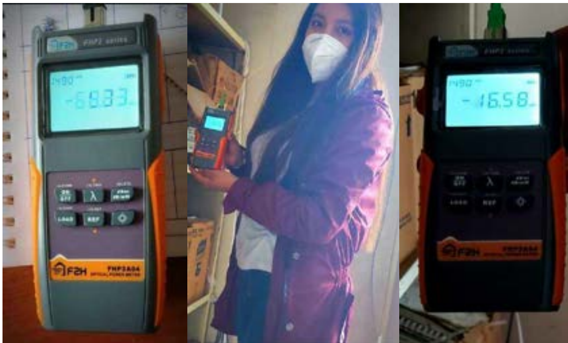
Figura 37: Medición de la potencia a través del Power Meter
