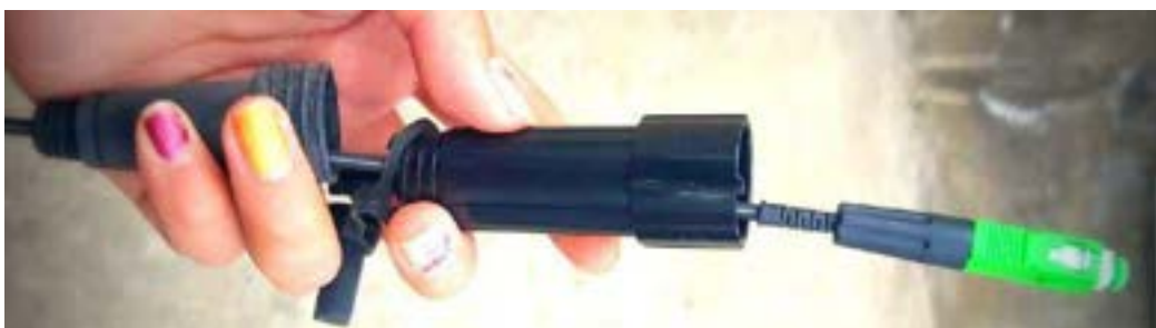
Figura 28: Colocación del conector mecánico
