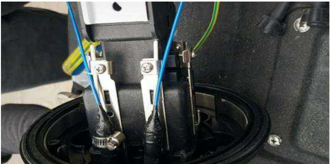
Figura 15: Sujeción del cable de tensión a la manga
