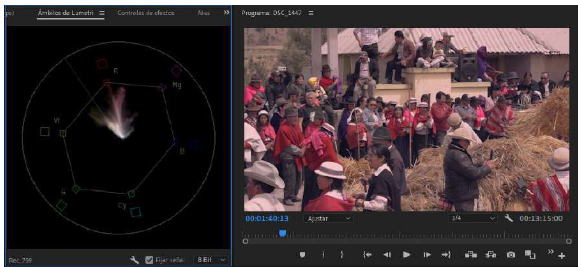
Ilustración 14-4: Uso de vectorscopio para evitar saturación excesiva
