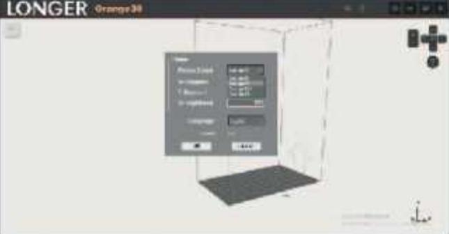
Seleccionamos el modelo de la impresora que vamos a usar en donde se nos ajusta el tamaño del área de impresión.
