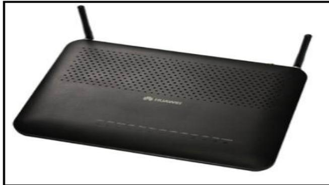
**Figura 11-1.** Terminal de Red Óptica
