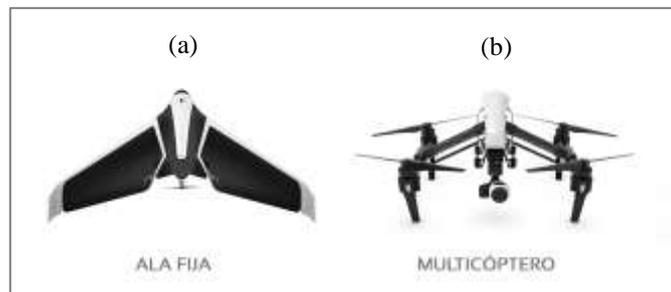
**Figura 14-1:** Drones de ala fija y ala rotatoria
