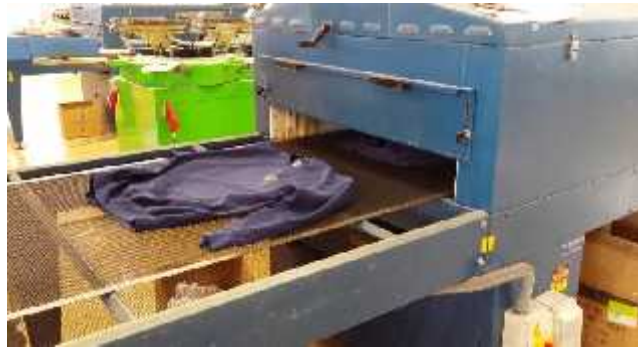
Ilustración 78-2: Etapa de secado en serigrafía.
