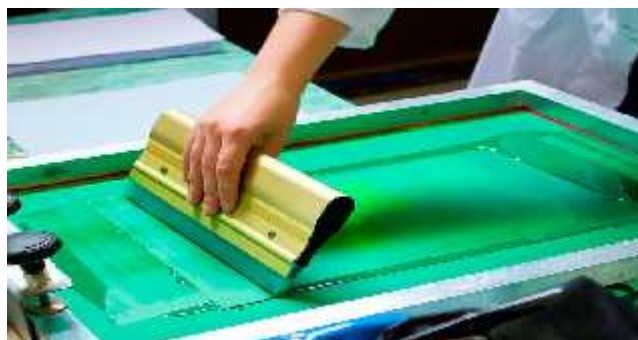
Ilustración 75-2: Aplicación de la emulsión.
