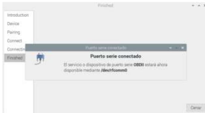
Figura 24-3. Asignación del puerto serie a OBD-II Realizado por: CARDOSO Cristhian, 2021.
