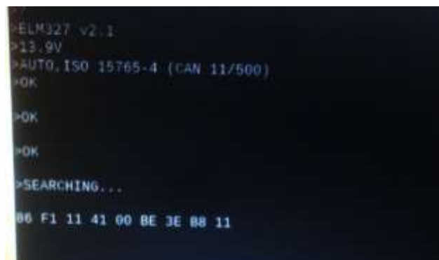
Figura 25-3. Lectura y configuración del ELM327 mediante minicom Realizado por: CARDOSO Cristhian, 2021.
