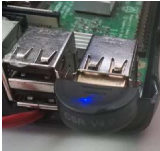
Figura 41-4. Módulo Bluetooth en marcha Realizado por: CARDOSO Cristhian, 2021.
