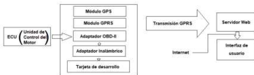
Figura 2-3. Diagrama de bloques del sistema de extracción de datos. Realizado por: CARDOSO Cristhian, 2021.
