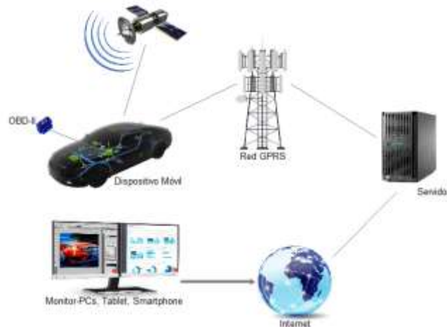
Figura 9-3. Diagrama lógico del Sistema de extracción de parámetros OBD-II Realizado por: CARDOSO Cristhian, 2021.
