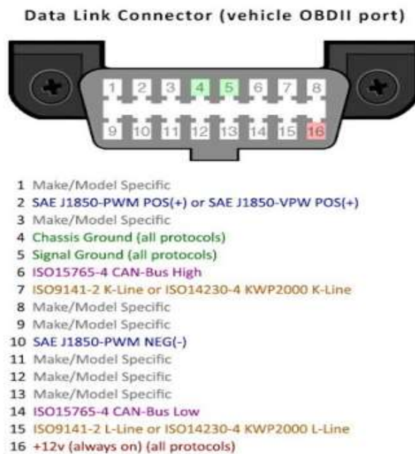
Figura 3-2. Estructura del conector de diagnóstico OBD-II. Fuente: BERNIAS Gonzalo, 2015.
