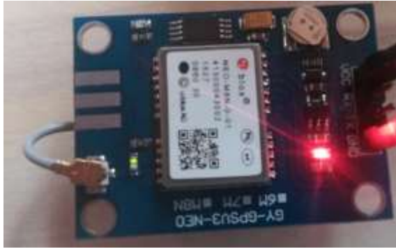
Figura 39-4. Módulo GPS en marcha Realizado por: CARDOSO Cristhian, 2021.
