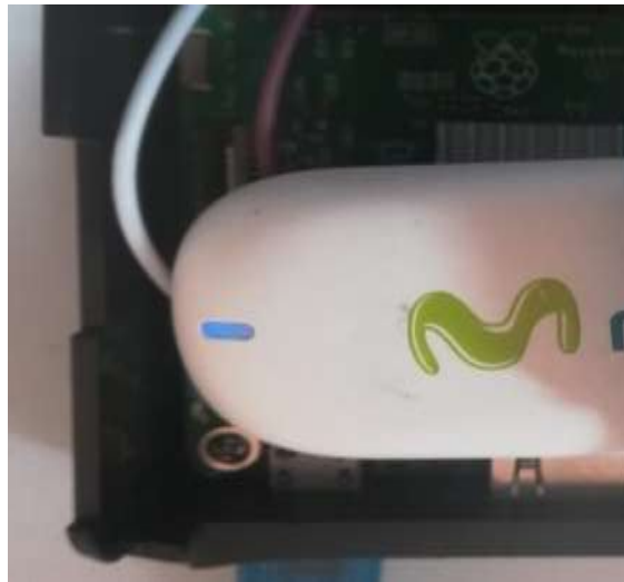
Figura 40-4. Módulo GPRS en marcha Realizado por: CARDOSO Cristhian, 2021.
