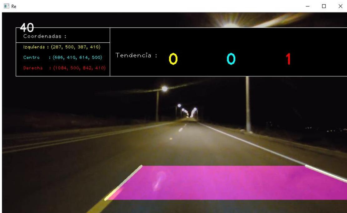
**Figura 50-2.** Superposición de recursos gráficos para el monitoreo del seguimiento de carril
