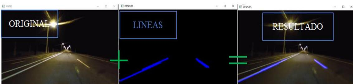
**Figura 45-2.** Superposición de la imagen con líneas y la imagen original
