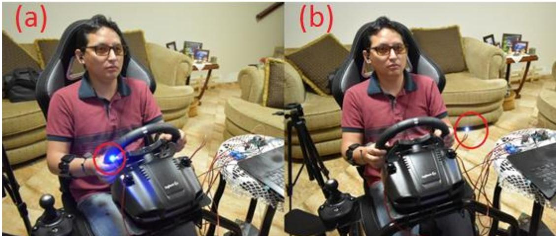
**Figura 79-3.** Entorno de simulación para evaluación de los tipos de alertas – alerta visual.
