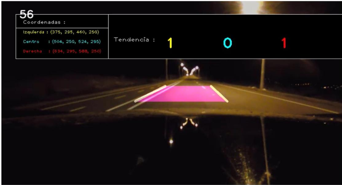
**Figura 61-3.** Identificación carril con la cámara entre el capó y el parabrisas del automóvil.
