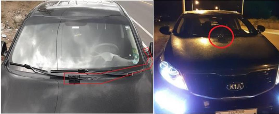
**Figura 55-3.** Prueba en día-noche posición de cámara entre el capó y el parabrisas.
