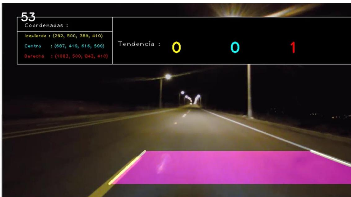
**Figura 63-3.** Identificación carril con la cámara en la parte frontal del automóvil
