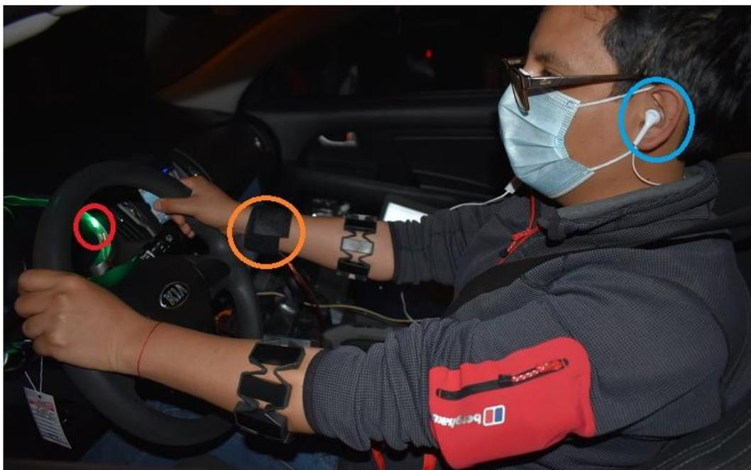
**Figura 81-3.** Instalación de hardware para gestión de señales de alerta en el auto
