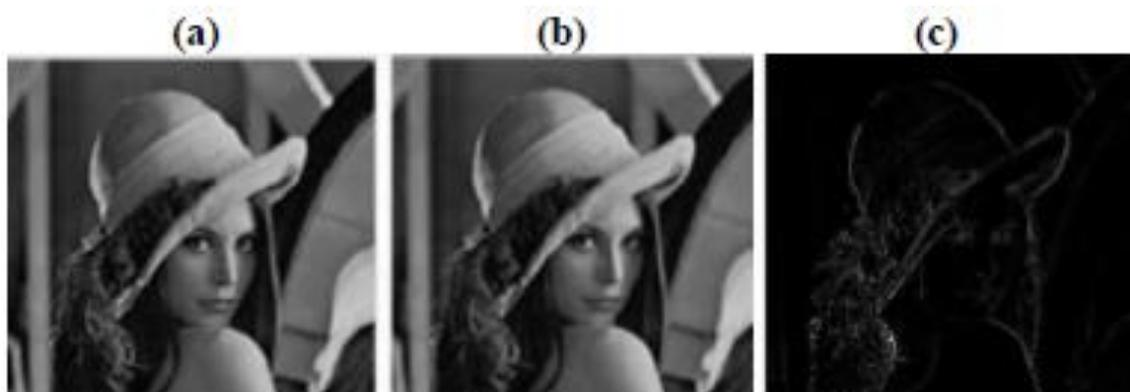
**Figura 22-1.** (a) Imagen original. (b) Aplicación de filtro promedio  $3 \times 3$ . (c) Aplicación de filtro Laplaciano
