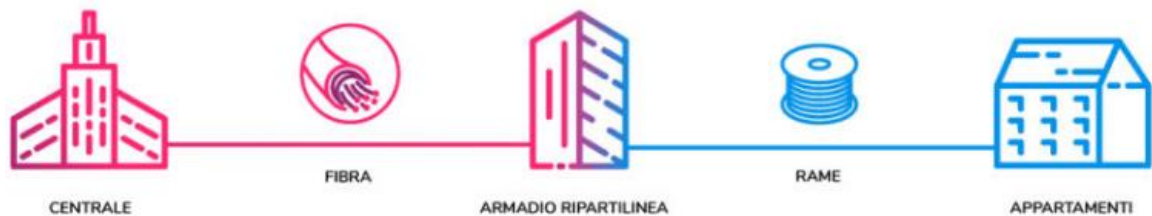
Figura 0-16: Arquitectura de redes ópticas FTTC
