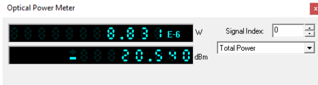
Figura 3-87: Potencia en la ONT downstream.
