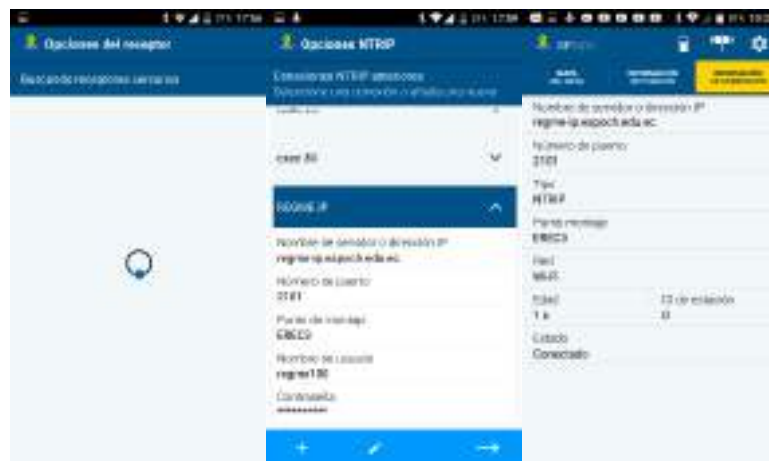
Figura 9-2. Vinculación del receptor con el colector
