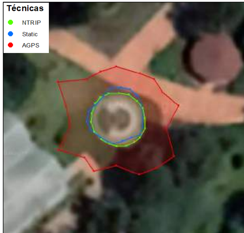
Figura 5-3. Puntos tomados en el terreno Circular
