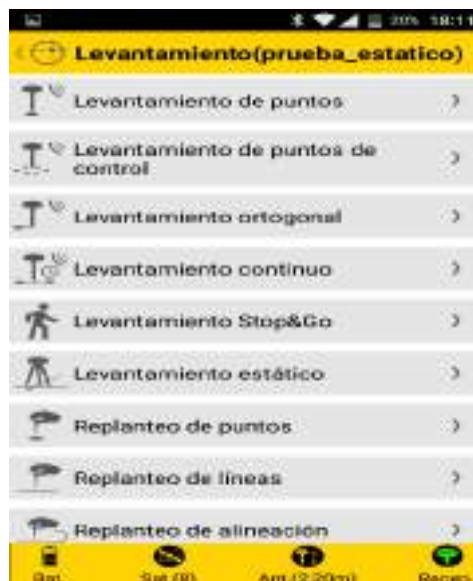
Figura 5-2. Elección del levantamiento estático
