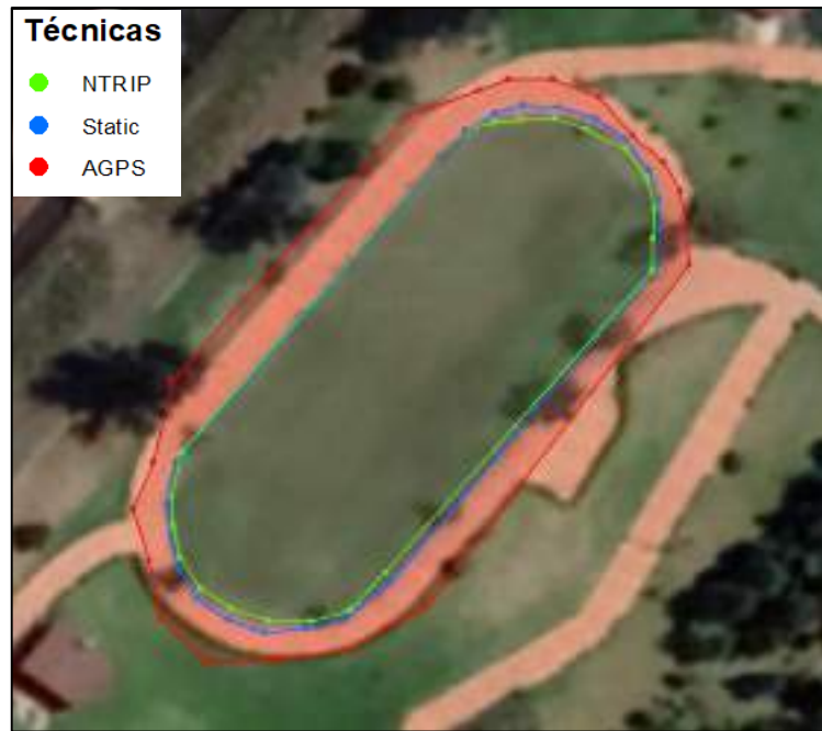
Figura 3-3. Puntos tomados en el terreno Ovalado
