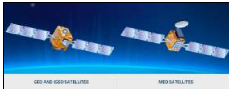
Figura 5-1. Tipos de Satélites BEIDOU a) Órbita GEO y IGSO, b) Órbita MEO
