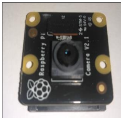
Figura 3-2: Pi NoIR Camera V2. Realizado por: Berrones A, Crespata C; 2021.
