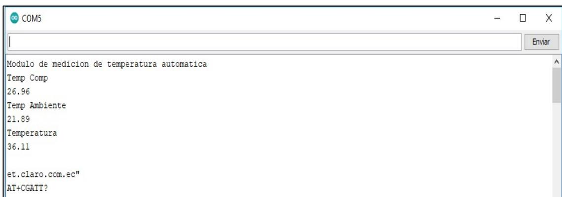
**Figura 8-3:** Monitoreo de medición de temperatura corporal en Arduino IDE.
