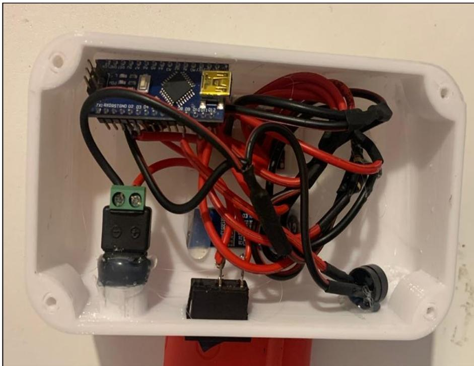
**Figura 15-2:** Módulo de medición de temperatura corporal físico.
