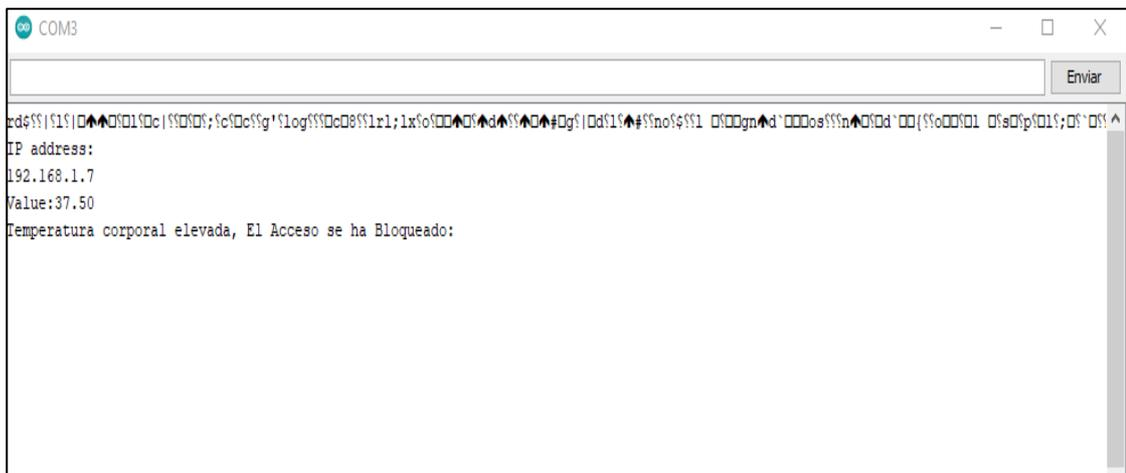
**Figura 13-3:** Monitoreo de bloqueo de acceso automático al usuario en Arduino IDE.
