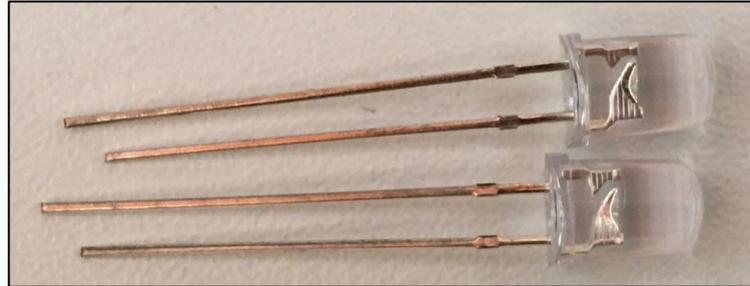
**Figura 10-2:** Diodos LED rojo y verde de alta intensidad
