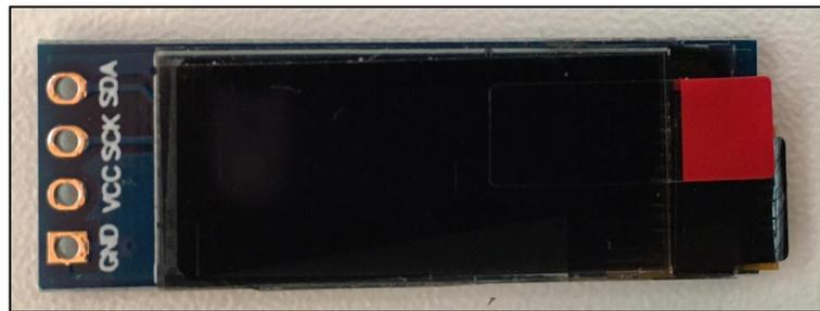
**Figura 11-2:** Pantalla Oled de 0.91 pulgadas
