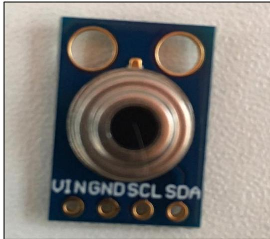
**Figura 6-2:** Sensor de temperatura infrarroja MLX90614
