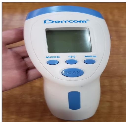
**Figura 1-3:** Pistola de medición de temperatura Berrcom JXB182
