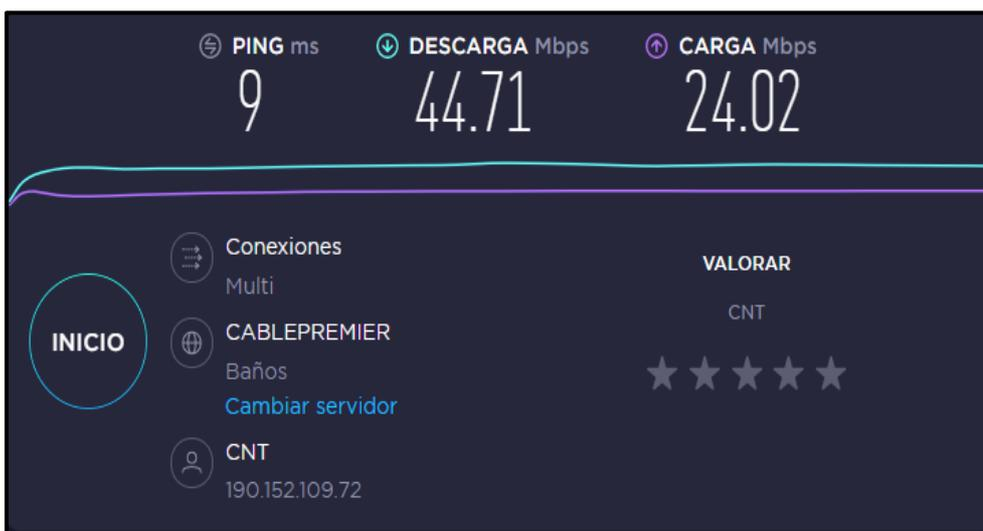
**Figura 4-3:** Velocidad de transmisión y recepción de datos de la red WLAN empleada para la prueba de conexión medida en Open Speed Test.
