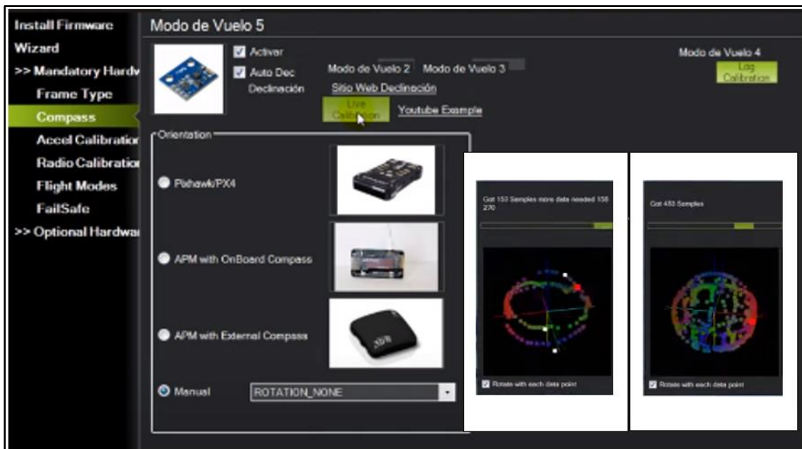
Figura 21-3. Pantalla de visualización al calibrar la brújula Realizado por: Reinoso Orozco, Katerine, 2021
