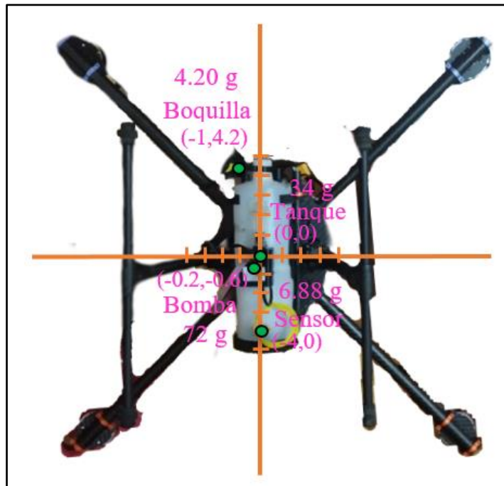
Figura 15-3. Distribución de los elementos en el plano Realizado por: Reinoso Orozco, Katerine, 2021
