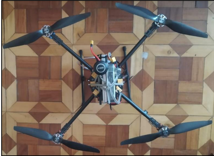
Figura 31-3. Montaje de las hélices sobre los motores del Vant Realizado por: Reinoso Orozco, Katerine, 2021
