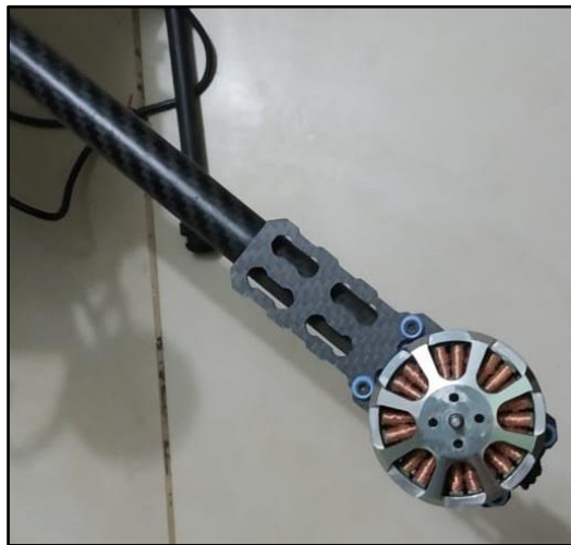
Figura 27-3. Montaje del motor en el frame con tornillos
