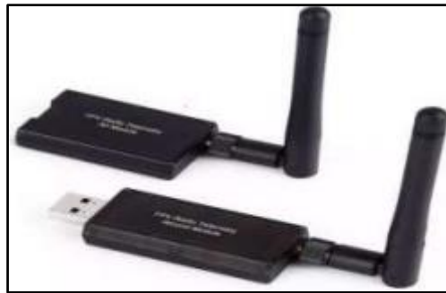
Figura 13-2. Módulo de telemetría Fuente: (Suqui y Paredes, 2019, p.26)
