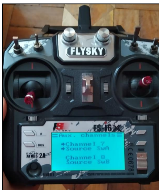
Figura 26-3. Configuración del canal auxiliar
