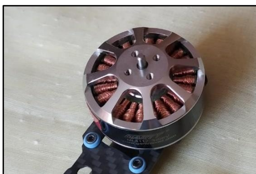
Figura 10-3. Motor brushless 320KV
