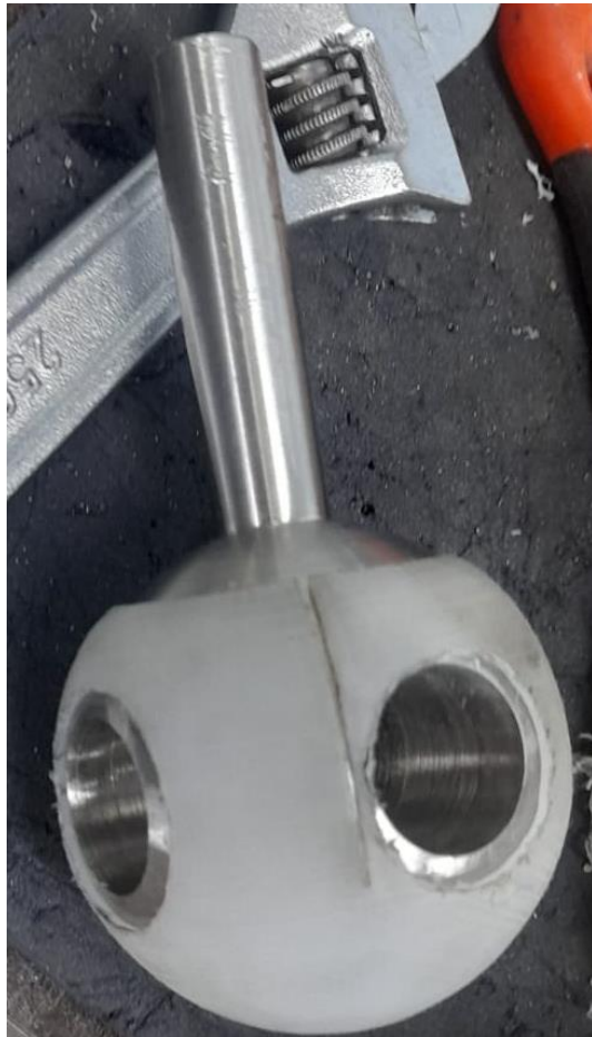
ANEXO 8-D. Bola y recubrimientos acoplados.
