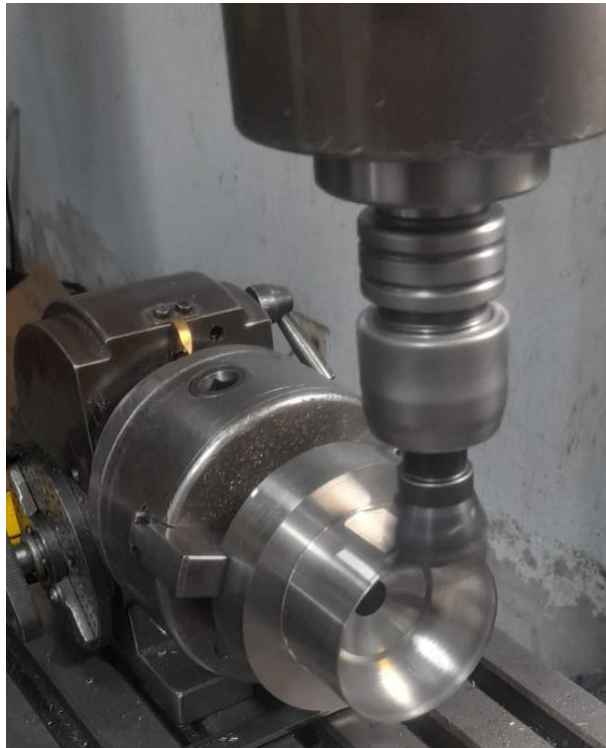
ANEXO 18-D. Maquinado de tapa frontal de válvula
