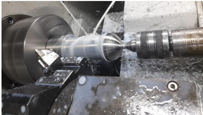
ANEXO 6-D. Mecanizado de bola de válvula
