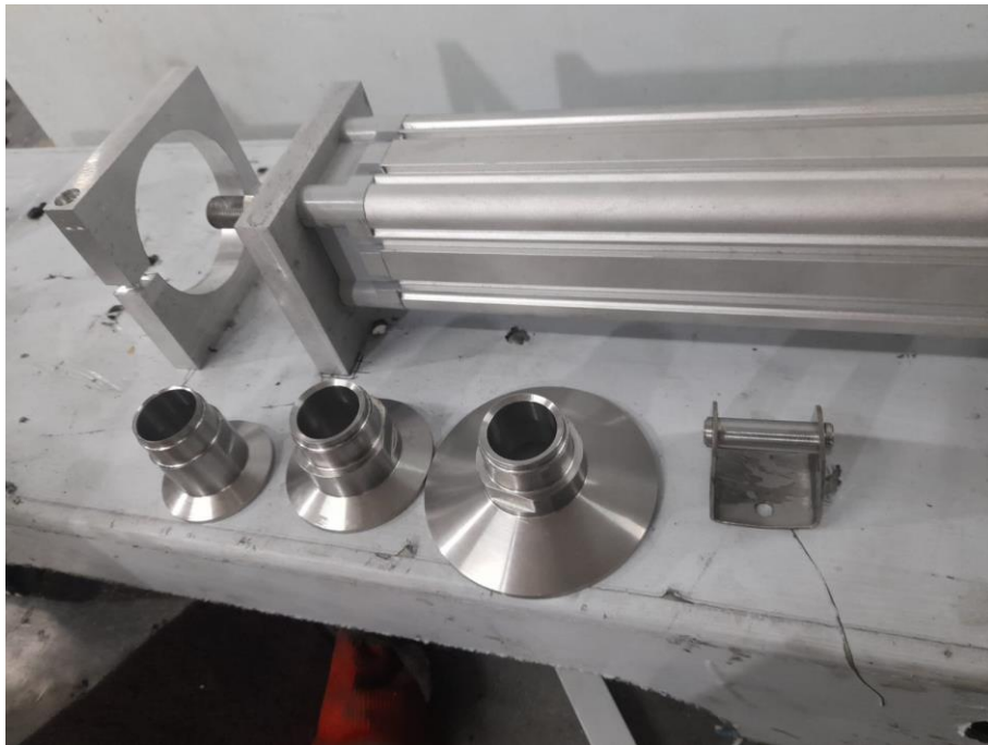
ANEXO 4-D. Ferrules y bases de cilindros neumáticos mecanizados
