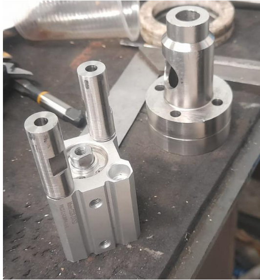
ANEXO 15-D. Acople cilindro neumático y boquilla
