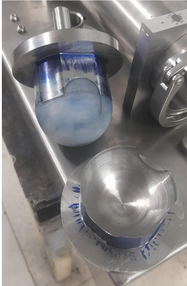
ANEXO 17-D. Acabado de tapa, bola y recubrimiento de válvula
