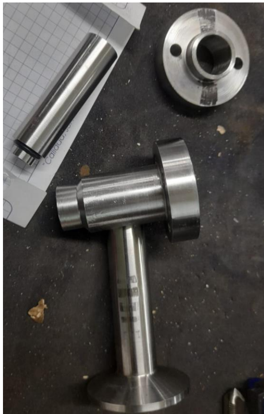
ANEXO 14-D. Elementos de boquilla maquinados
