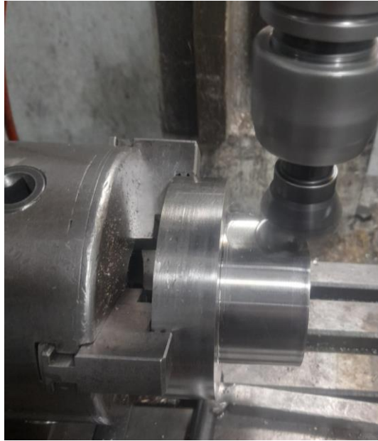
ANEXO 9-D. maquinado de tapas de válvula.
