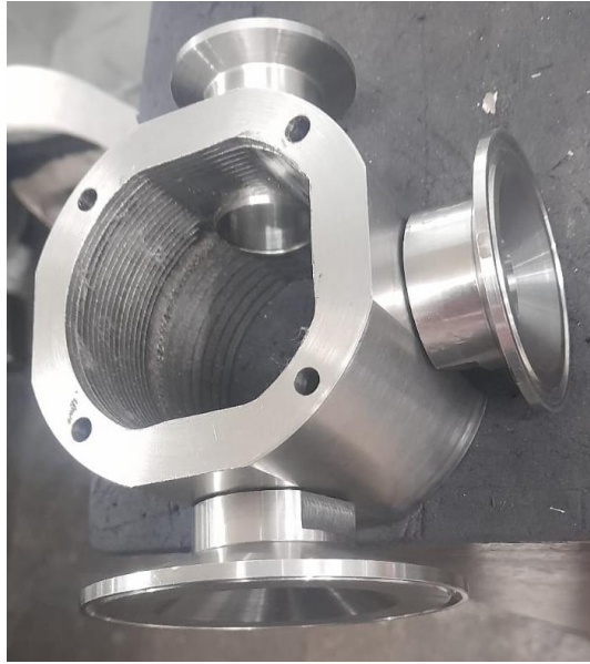
ANEXO 13-D. Prueba de cuerpo y ferrules de válvula
