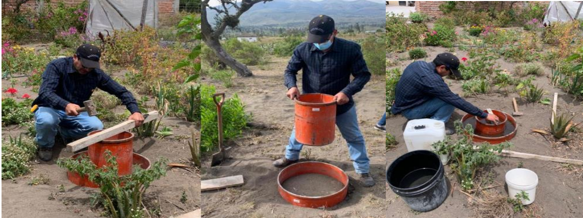
Figura 2-3. Prueba de infiltración con infiltrómetro de doble cilindro Realizado por: Velasco, Iván, 2023
