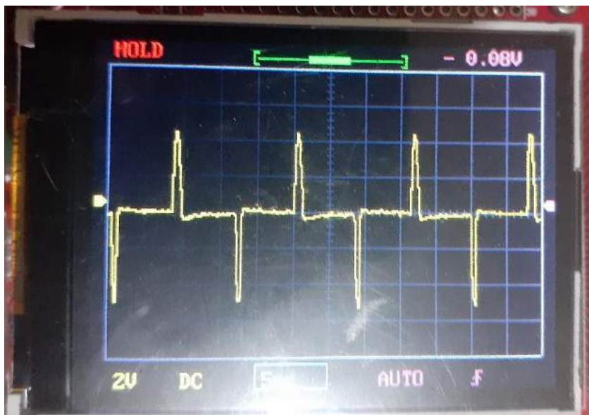
Figura 81: Señal de salida del inversor con carga a 60 Hz y ángulo de 80 grados.
