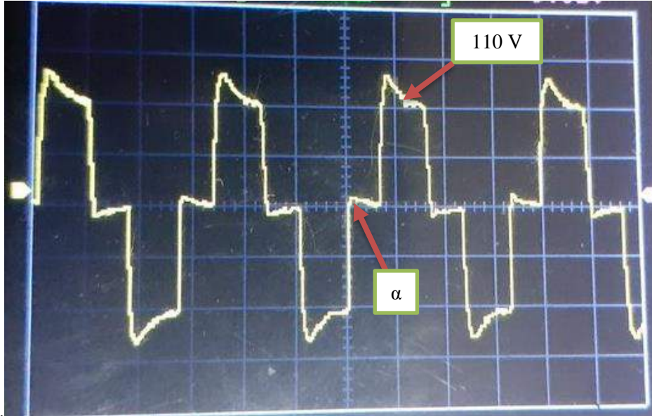
Figura 88: Voltajes de la señal de onda cuadrada compuesta.
