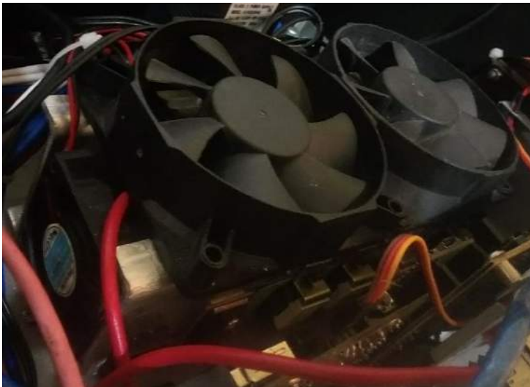
Figura 56: Ventiladores del circuito driver.
