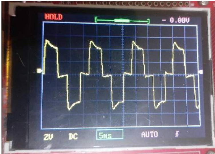
Figura 82: Señal de salida del inversor con carga a 60 Hz y ángulo de 30 grados.
