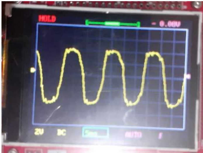
Figura 84: Señal de salida del inversor con carga a 60 Hz y 25 divisiones.
