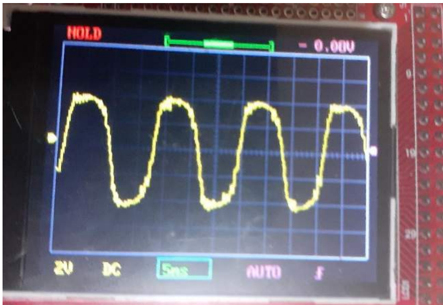
Figura 83: Señal de salida del inversor con carga a 60 Hz y 10 divisiones.
