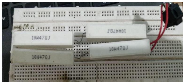
**Figura 16-3.** Resistencias de potencia conectadas en serie y paralelo usadas como carga en el sistema MPPT.
