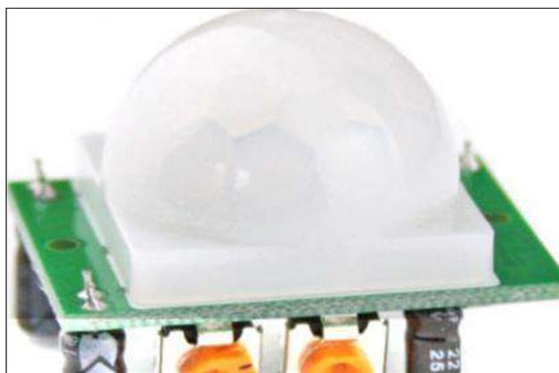
**Figura 9-3:** Sensor de movimiento PIR detector de presencia HC-SR501
