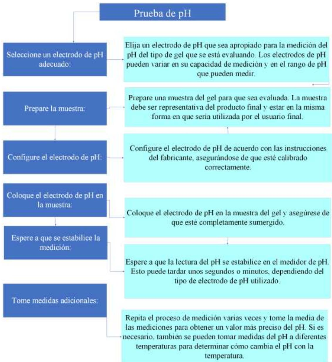
**Ilustración 3-5:** Diseño para la prueba de pH
