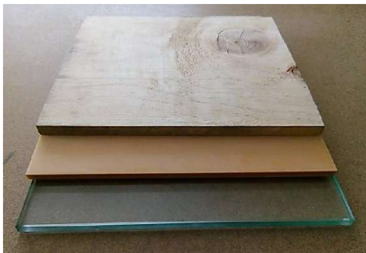
Figura 12-3: Vista frontal de las muestras de materiales dieléctricos utilizadas (madera, baquelita y vidrio).
