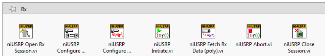
Figura 21-3: Bloques básicos de un receptor en LabVIEW.
