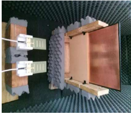
Figura 4-4: Sistema de medición para la baquelita con la técnica SDRdar 2.
