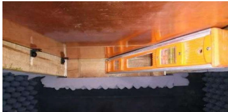
Figura 32-3: Preparación del conductor eléctrico de cobre con un nivelador de burbuja para asegurar una incidencia normal.
