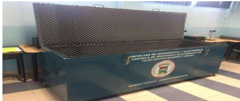
Figura 9-3: Cámara anecoica utilizada para las pruebas de caracterización de materiales dieléctricos con técnicas SDRadar.
