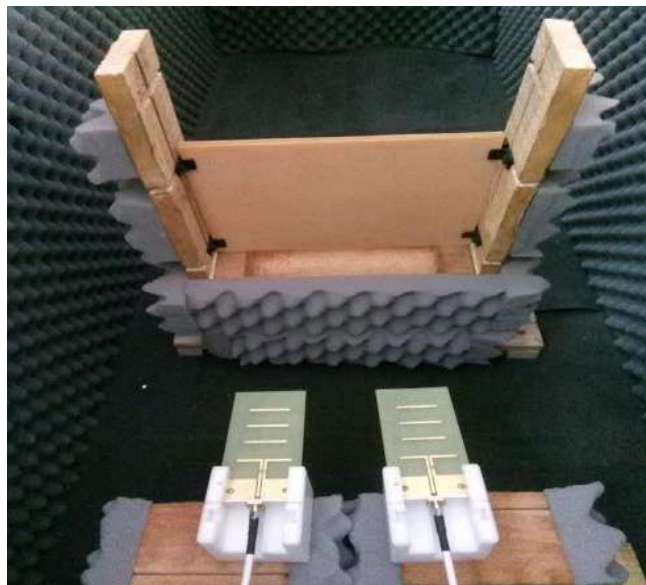
Figura 37-3: Escenario para la caracterizar la baquelita con la técnica SDRadar 1 a una distancia de 3\lambda .
