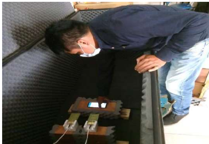
Figura 10-3: Medición de las variables atmosféricas dentro de la cámara anecoica con los sensores de un teléfono.
