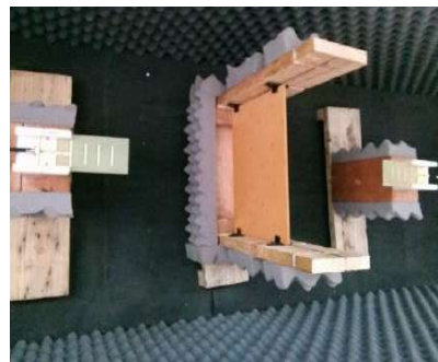
Figura 63. Implementación del sistema de caracterización con la técnica SDRadar 3.
