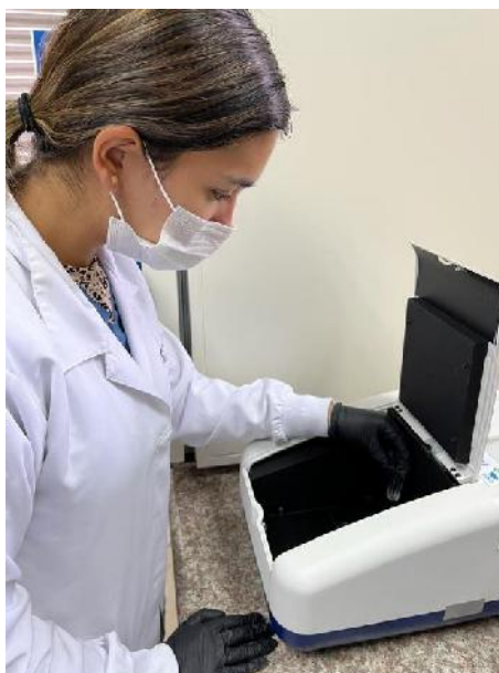
Ilustración 13-3: Medición de fósforo en el espectrofotómetro UV-VIS.
