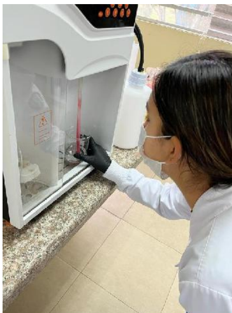
Ilustración 10-3: Uso del digestor Kjeldahl.
