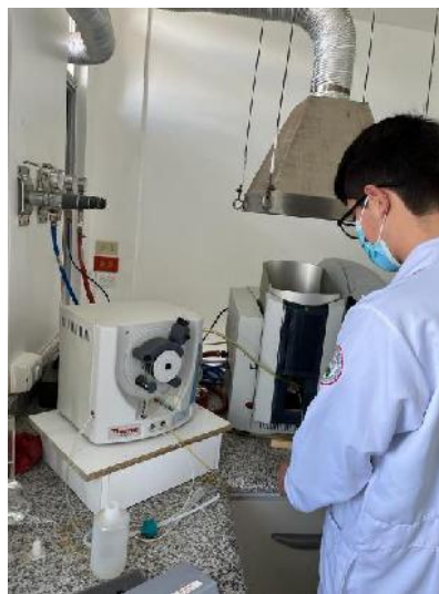
Ilustración 14-3: Lectura de las muestras en el espectrofotómetro de absorción atómica.
