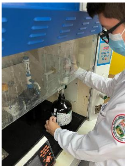
Ilustración 15-3: Preparación de la solución de \text{HNO}_3 1%.
