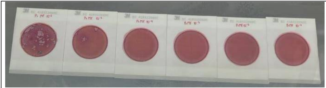
Ilustración 42: muestra final pila 1 resultados E.coli / Coliformes
