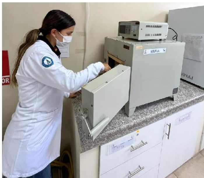
Ilustración 9-3: Colocación del crisol en la mufla.
