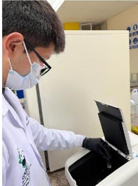
Ilustración 11-3: Medición de la muestra en el espectrofotómetro UV-VIS.
