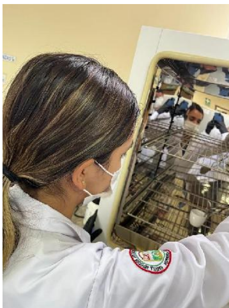
Ilustración 8-3: Colocación del crisol en la estufa.
