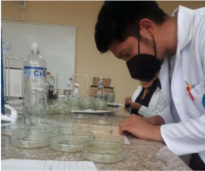
Figura 27-2: Medición de índice de germinación de Compost y Gallinaza
