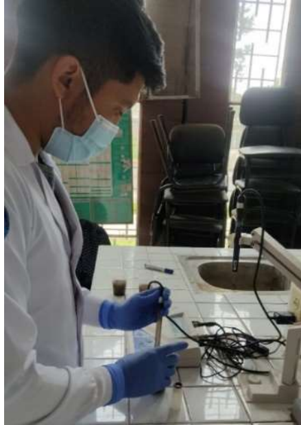
Figura 19-2: Medición de CE en suelos
