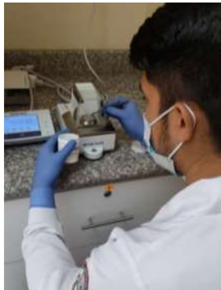
Figura 20-2: Pesaje en microbalanza
