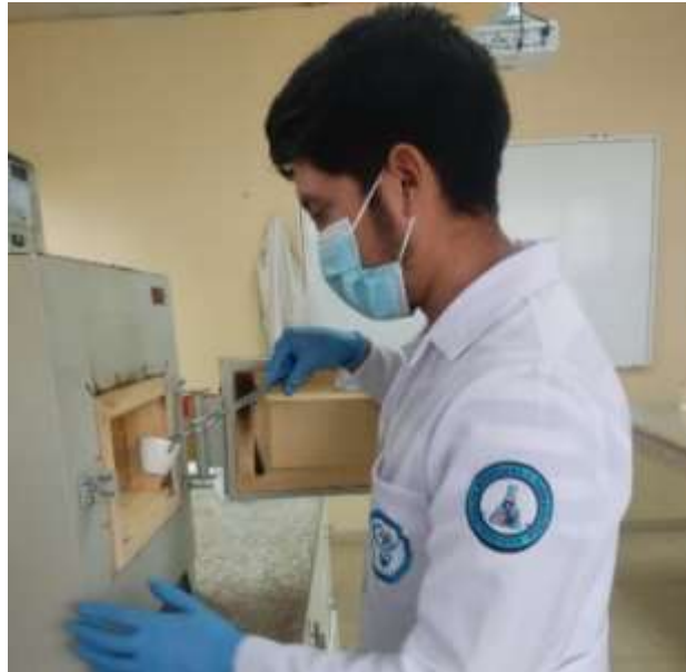
Figura 21-2: Determinación de MO por calcinación
