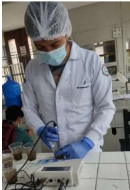
Figura 18-2: Medición de pH en suelo
