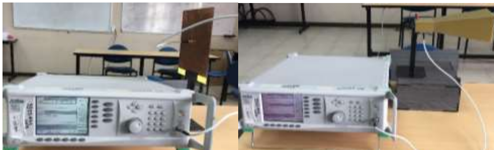
Figura 2-3. Pruebas con el generador de señales ANRITSU de los sistemas radiantes directivos.
