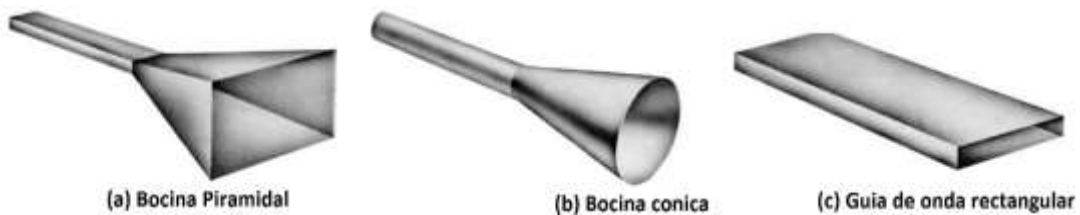
Figura 7-1. Configuración de antenas de apertura. (a) Antena corneta piramidal, (b) Antena corneta cónica, (c) Guía de onda rectangular.
