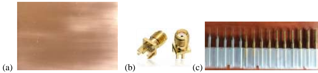
Figura 19-2. Materiales y elementos electrónicos. (a) Placa(baquelita) FR4, (a) conector SMA Hembra, (c) kit brocas fresas 0.1mm-3.7mm.
