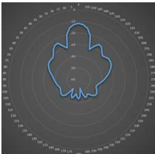
Gráfico 2-3. Patrón de radiación polar del sistema de arreglo de antenas parche 4x4 microstrip Banda-S.
