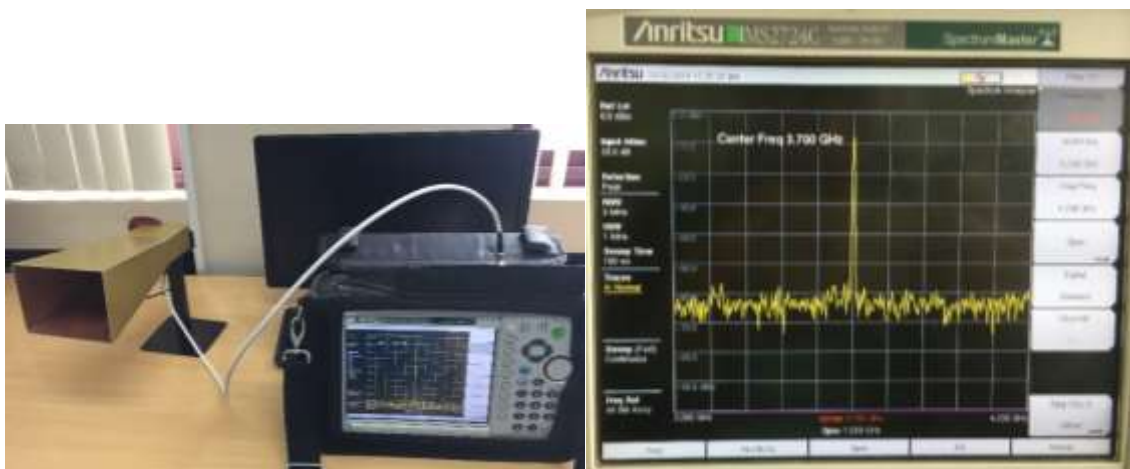
Figura 4-3. Pruebas con el analizador de espectro rotando la antena 360 grados la antena bocina piramidal banda-S.
