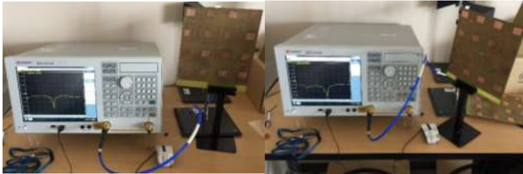
Figura 5-3. Pruebas con el analizador de redes vectoriales del arreglo de antenas parche 4x4 microstrip banda-S.
