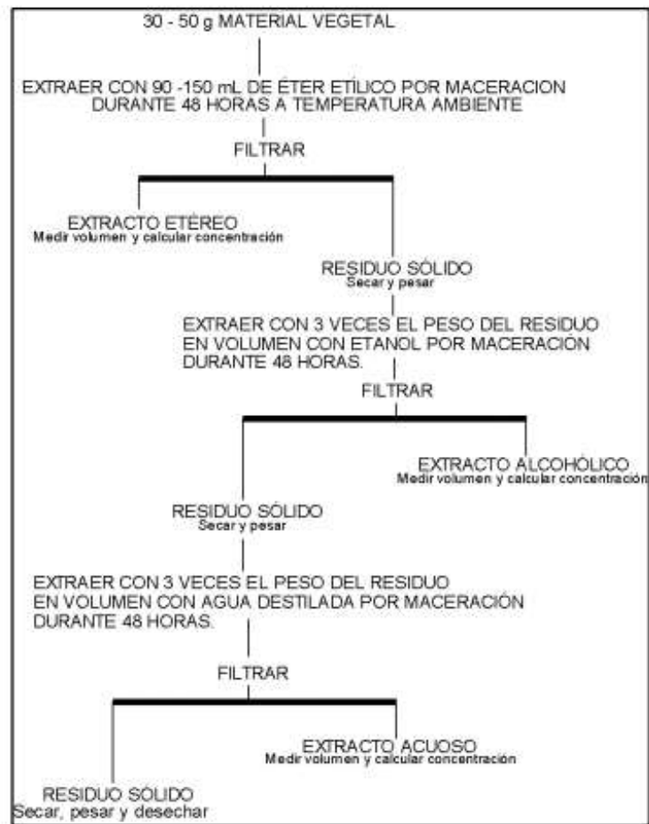
Ilustración 1-2: Esquema de extracción de metabolitos secundarios
