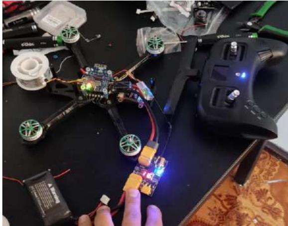
**Ilustración 4-D:** Sincronización radio control con receptor.
