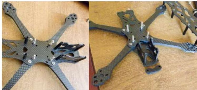
**Ilustración 4-9:** Conexión abrazadera y placas laterales.
