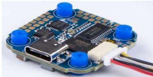
**Ilustración 3-26:** Controlador de vuelo marca flight succeX-E Mini F7 2-6S.
