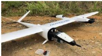
**Ilustración 2-13:** Dron ala fija eVTOL y UAV LiDAR.
