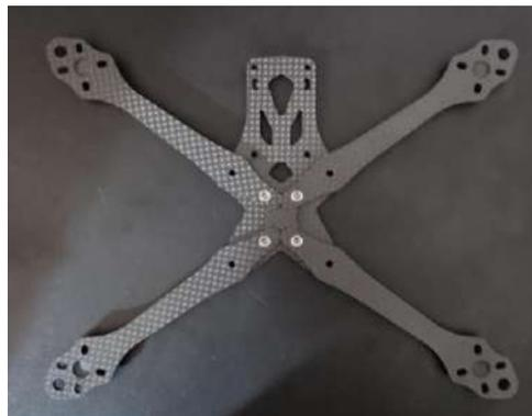
**Ilustración 4-5:** Conexión brazos cuadricóptero con conector brazo.
