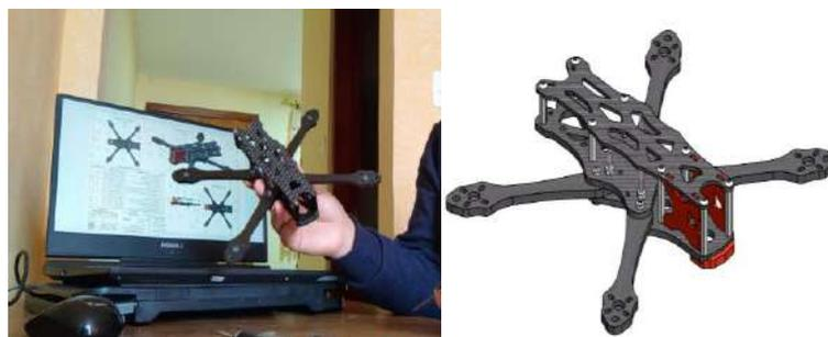
**Ilustración 4-10:** Ensamble general frame.
