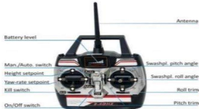
**Ilustración 3-31:** Radio control de cuatro canales.
