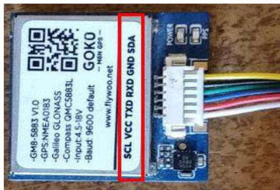
**Ilustración 4-15:** Pines de conexión GPS.
