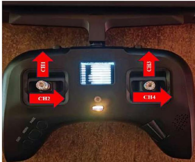
**Ilustración 1-C:** Movimientos principales del cuadricóptero.
