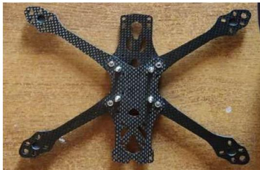
**Ilustración 4-7:** Ensamble bastidor inferior y bastidor intermedio.
