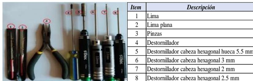
**Ilustración 4-2:** Herramientas necesarias para el montaje del frame.
