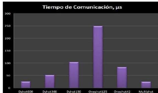
**Ilustración 3-19:** Tiempos de comunicación de firmware Dshot.
