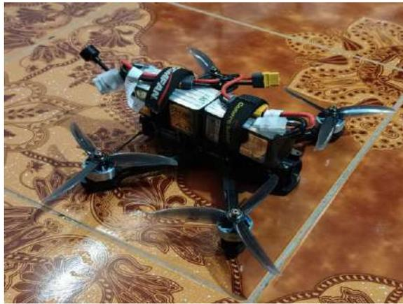
**Ilustración 4-24:** Conexión en paralelo batería LiPo.
