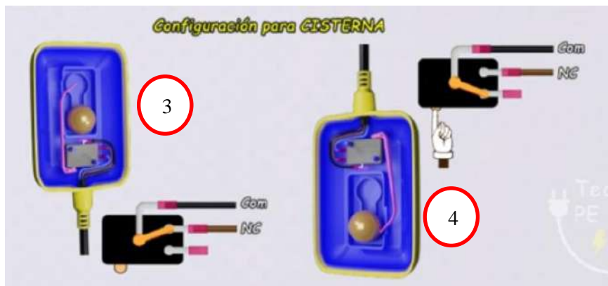
Ilustración 3-18: Configuración para cisterna
