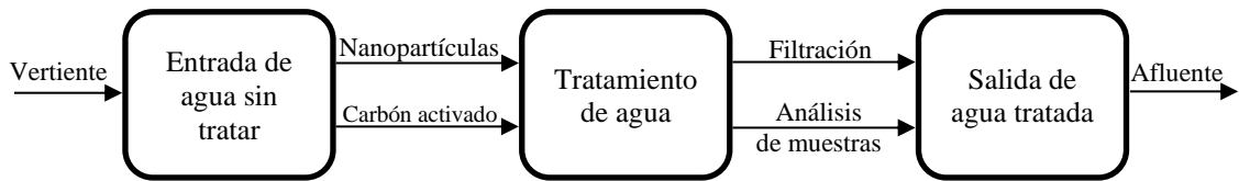
Ilustración 3-4: Análisis modular del sistema de tratamiento de agua
