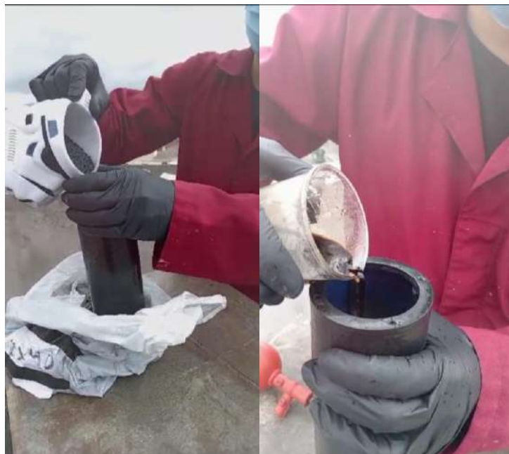
Ilustración 4-17: Colocación de carbón activado y nanopartículas
