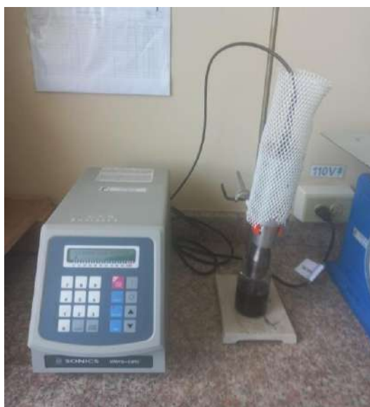
Ilustración 4-10: Nanopartículas en máquina de ultrasonido
